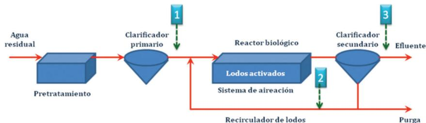
Figura 1.- Diagrama de flujo de la PTAR de Toluca, México. Las líneas punteadas muestran los diferentes puntos de muestreo para el presente estudio.
