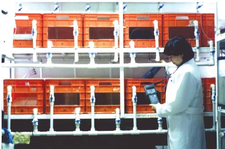
Figura. 4. Monitoreo diario de parámetros fisicoquímicos en el sistema de mantenimiento de 600L.
