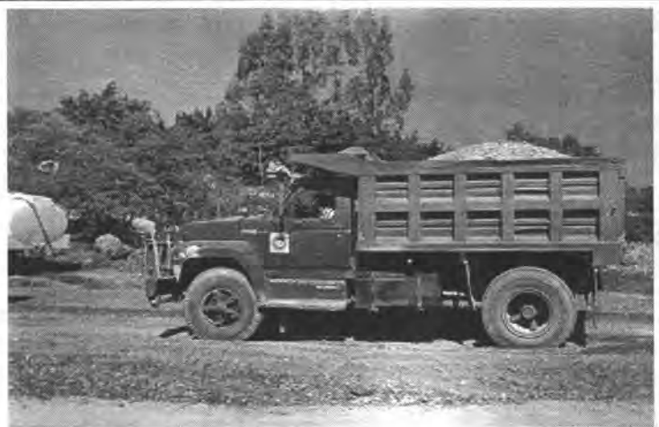
Foto 2.8 Camión de volteo con material para revestimiento de caminos
