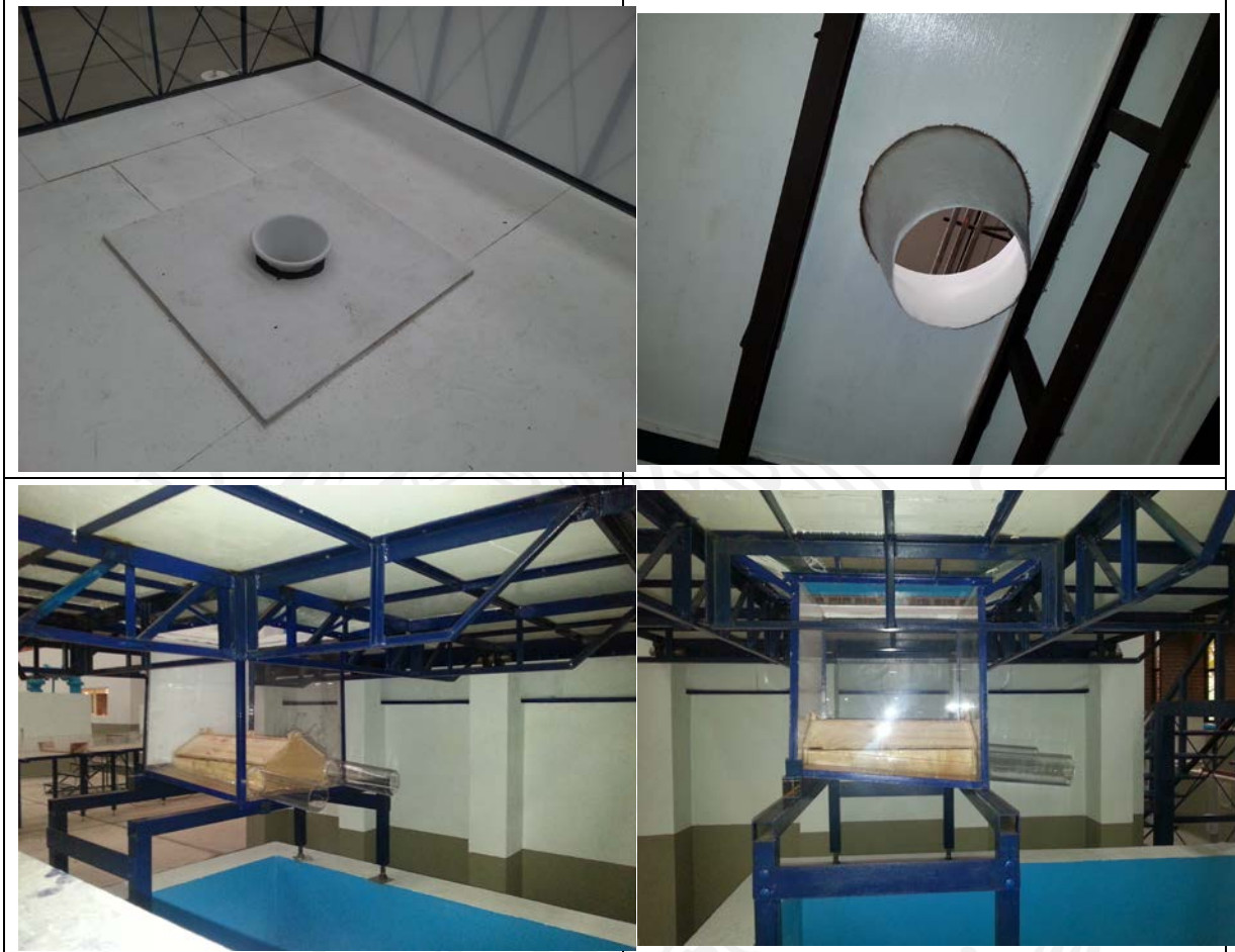
Ilustración 5.11 Bocas de tormenta y su dispositivo de ensaye
