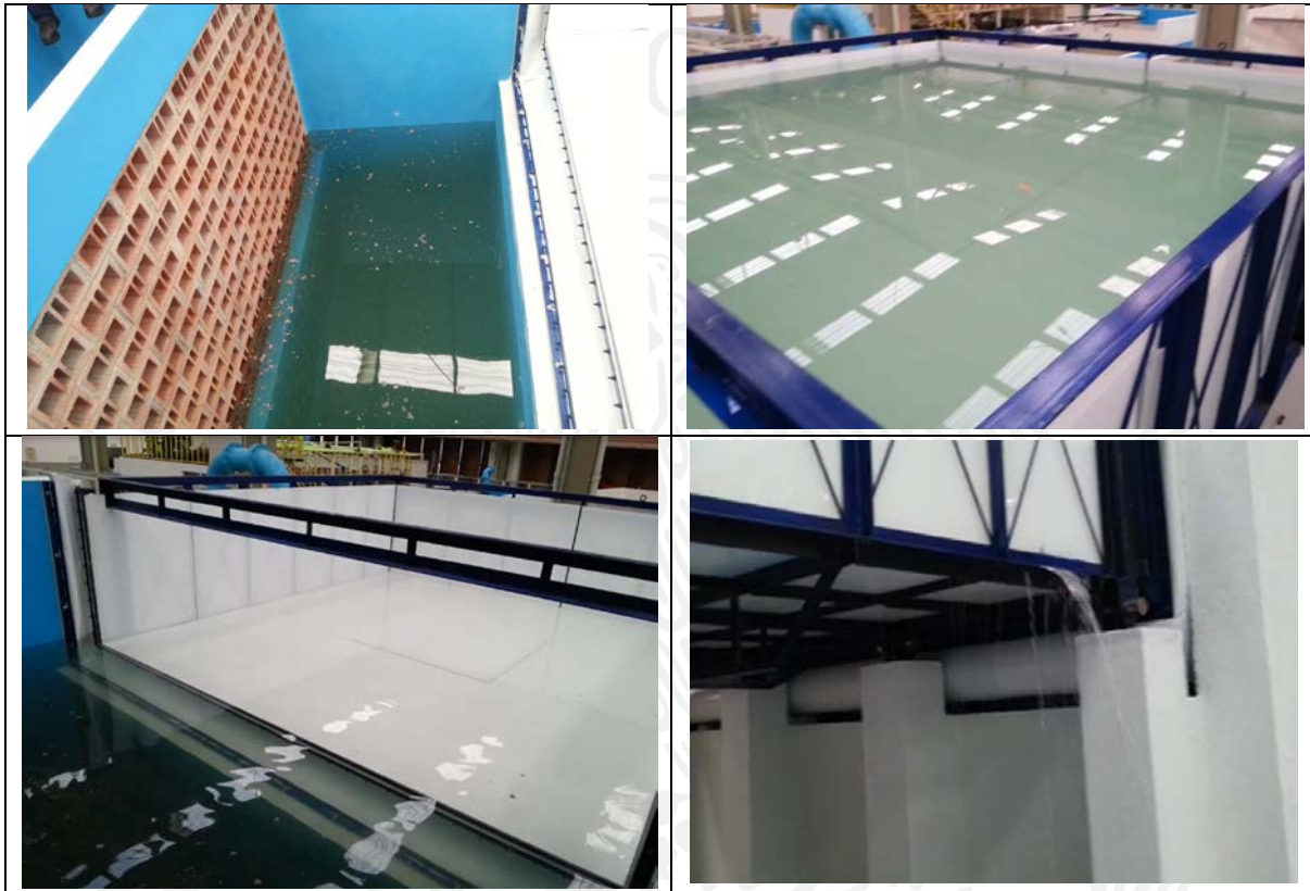
Ilustración 5.5 Prueba de llenado y hermeticidad
