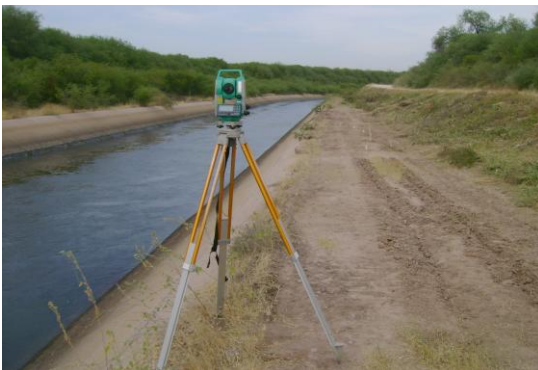
Foto 2.4. Equipo para marcar los sitios (y levantar la sección del canal en "B").
