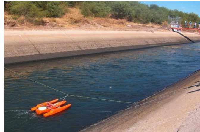
(d) Aforo con PD desde un cable tenso (modo "estacionario")
