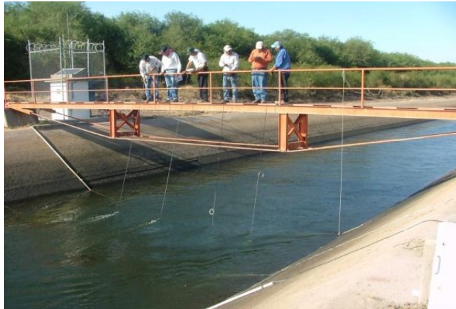
(a) Aforo con molinete "Price AA", cable y escandallo (mínimo 3 puntos por dovela, ángulo del cable < 30o)
