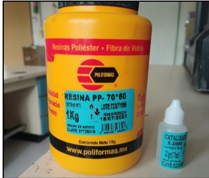
Figura 20: Resina PP 70/60 y su catalizador para proteger de la humedad los sensores.
