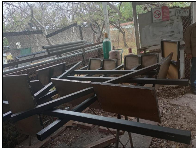
Figura 79: Bases de señalética terminadas
