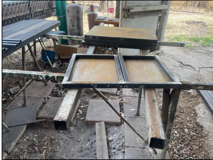
Figura 78: Limado de bases para la señalética.
