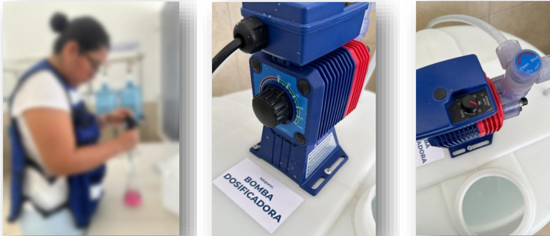
Figura 2. Determinación de la dosis de reactivos de remineralización y calibración de las bombas dosificadoras.
