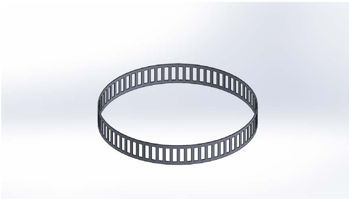
Figura 125 Vista general de abrazadera de fijación para malla de protección anti-aves
