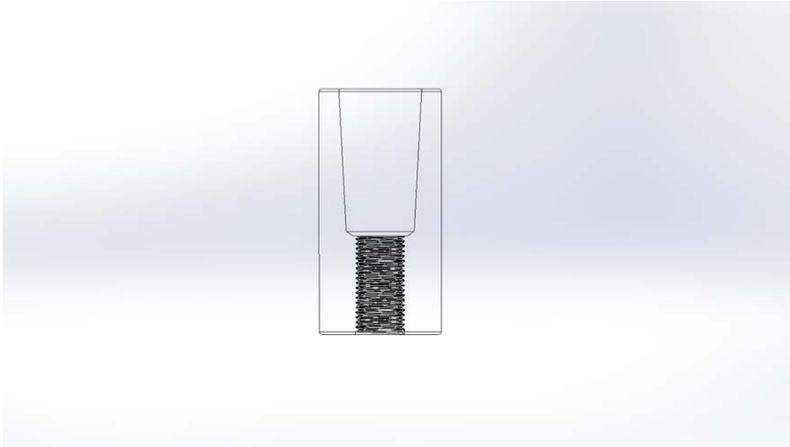
Figura 121 Diseño del cople, se puede observar el ángulo para la sujeción del embudo y la rosca para el inserto al colector
