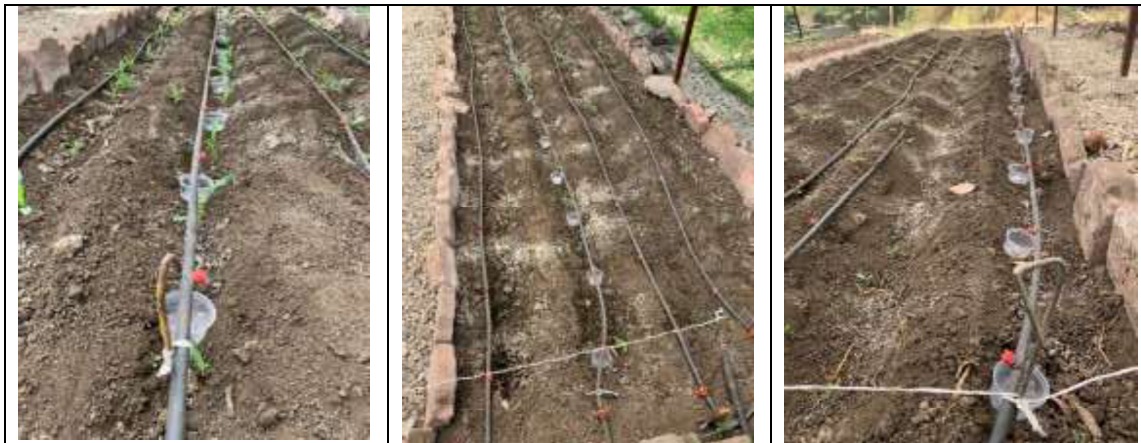
Figura 3. 10 Evaluación de gastos emisor/línea para los módulos de riego
