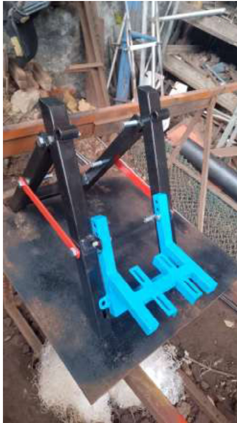
Figura 2.26. Soporte de la bici-bomba armado
