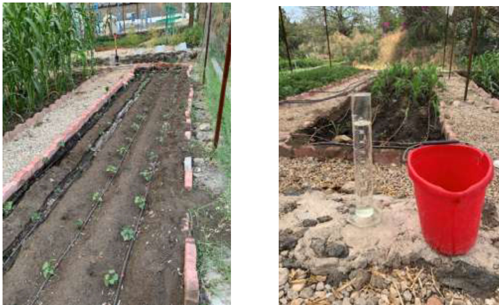
Figura 3. 11 Prueba de riego y medición del agua de riego por gravedad Para el módulo 1 se presentan las fases de almacenamiento y recesión, para el módulo 2 se observan las fases de almacenamiento y recesión, para el módulo 3 se tienen las fases de avance y almacenamiento y para el módulo 4 se exhiben las fases de avance y almacenamiento.
