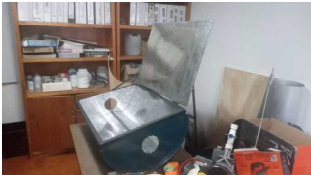
Figura 2.15. Colocación de las láminas reflectoras.
