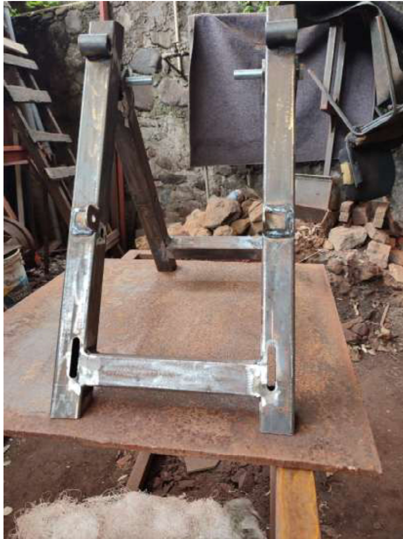
Figura 2.23. Subensamble del soporte en A.
