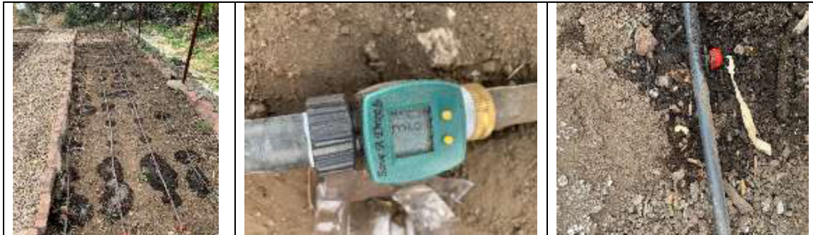
Figura 3. 9. Funcionamiento de los goteros y medición del gasto
