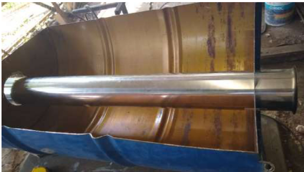
Figura 2.10. Tambo con los orificios donde pasará el receptor cilíndrico.
