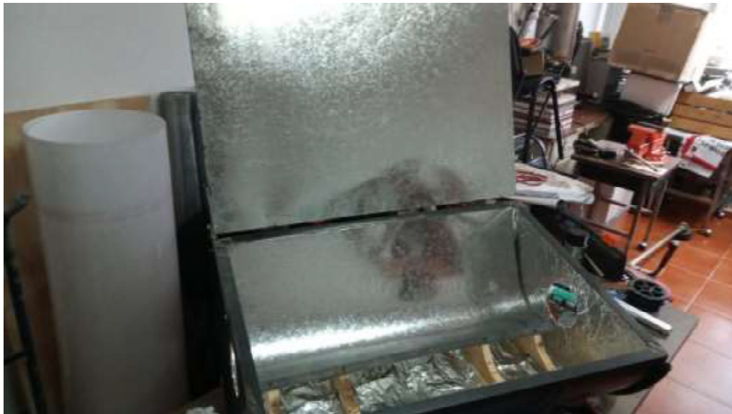
Figura 2.14. Colocación de una lámina reflectora.
