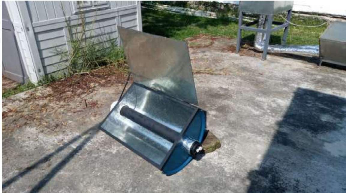
Figura 2.16. Cocina solar con el receptor instalado.
