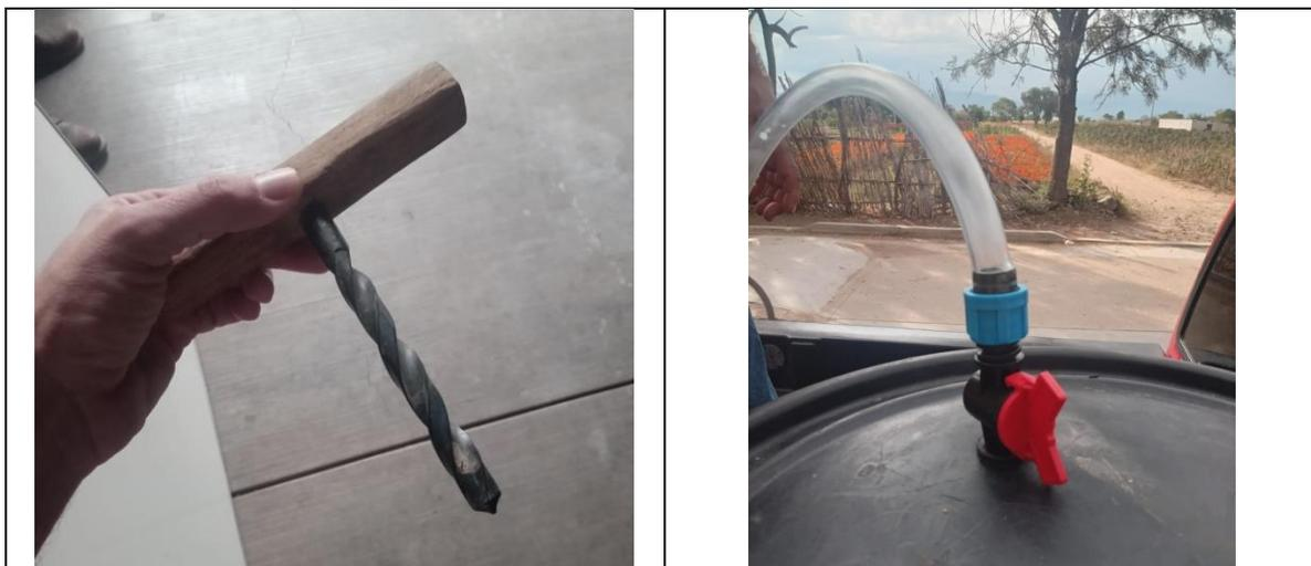
Fotografías 15 y 16: innovaciones “low-tech” por parte de los promotores, 1) un taladro manual y 2) una válvula de escape de gases hermética adaptable a los tambos, económica y fácil de conseguir en la localidad.
