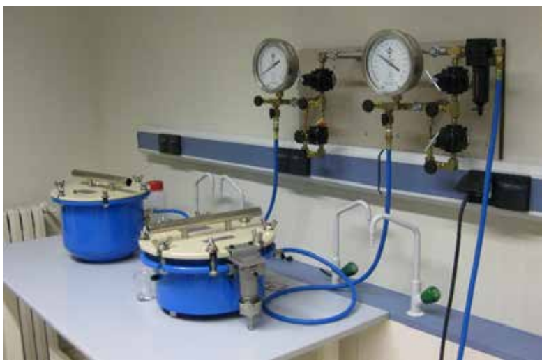
Membrana y olla de presión de laboratorio para obtener la curva de retención de humedad. Fuente: https://www.hydrogeophysicsndt.com/laboratorio-de-hidrologia/
