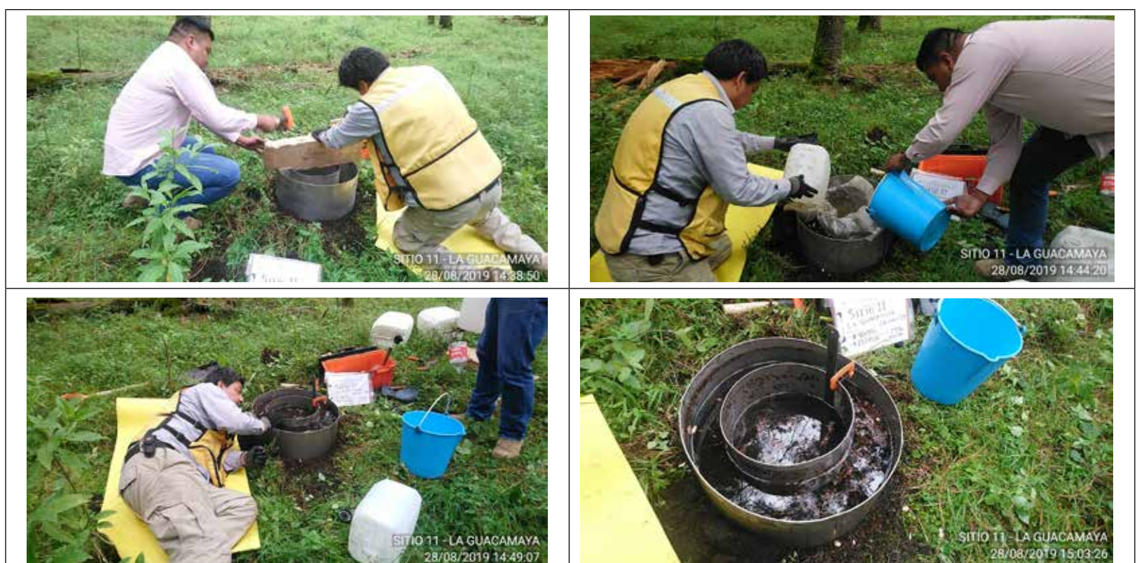
Figura 5.29. Trabajos de campo durante la realización de una prueba de permeabilidad.
