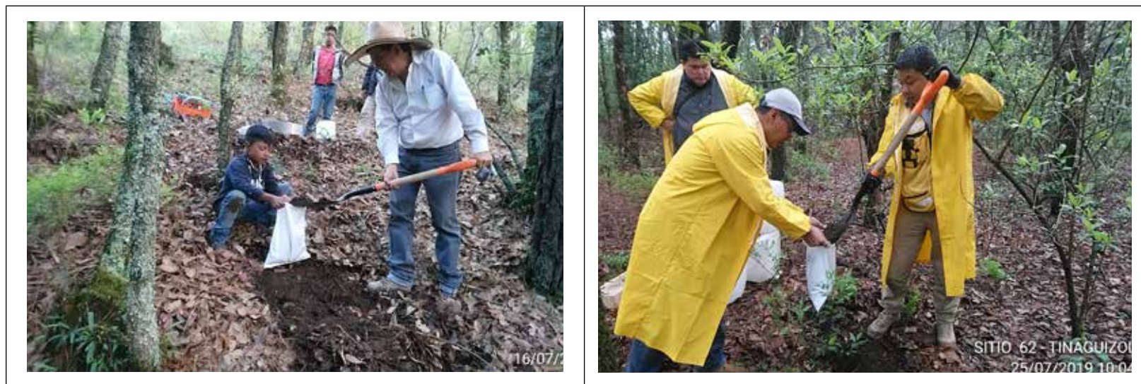
Figura 5.36. Toma de muestras de suelo para determinar permeabilidad en laboratorio.
