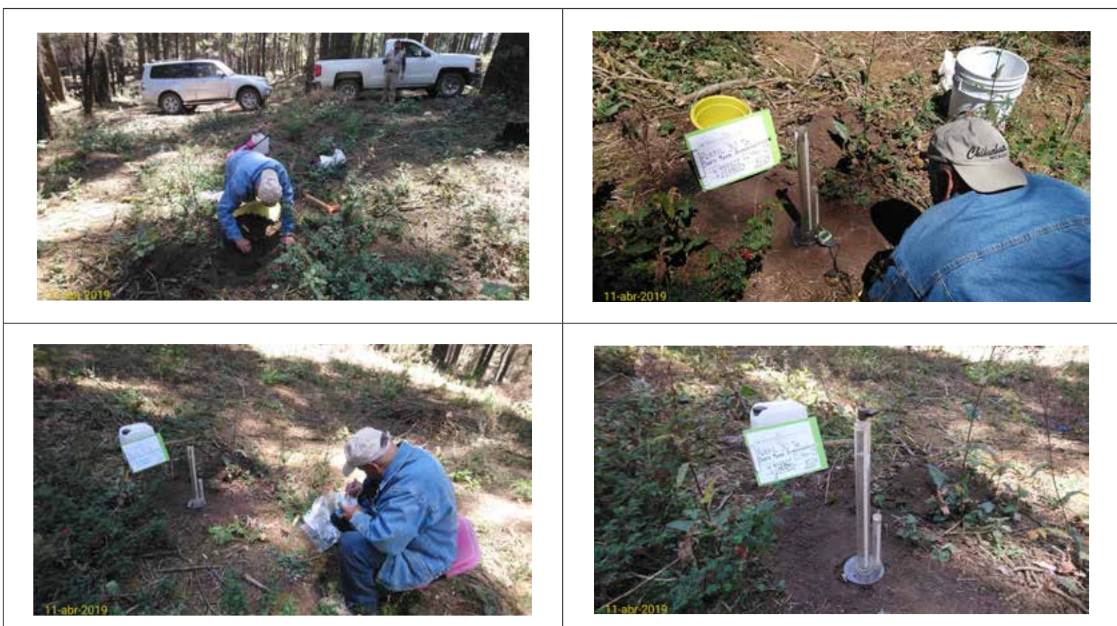
Actividades que se realizaron durante la prueba de permeabilidad con el permeámetro de disco.
