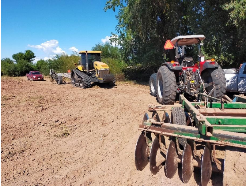
Ilustración 5. Maquinaria y equipo para el subsoleo y rastreo en Ráhum
