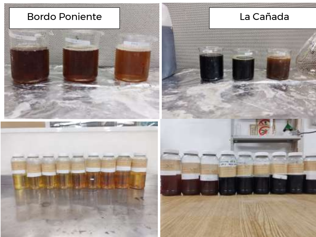
Figura 11 Coloración de lixiviados antes y después del pretratamiento con ozono y ozono+ultrasonido
