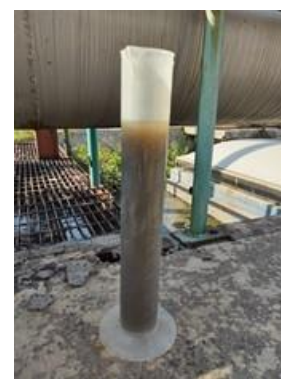
Figura 53 Lodos en prueba de sedimentación Unidad II, reactores 5-8
