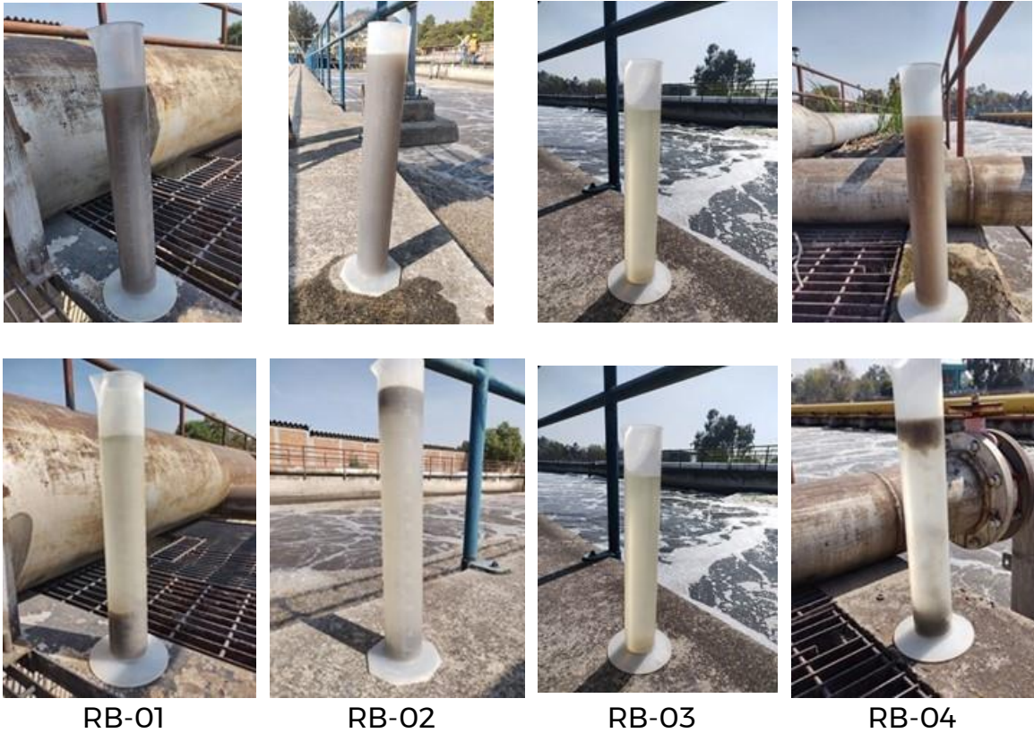
Figura 52 Lodos en prueba de sedimentación Unidad I, reactores 1-4
