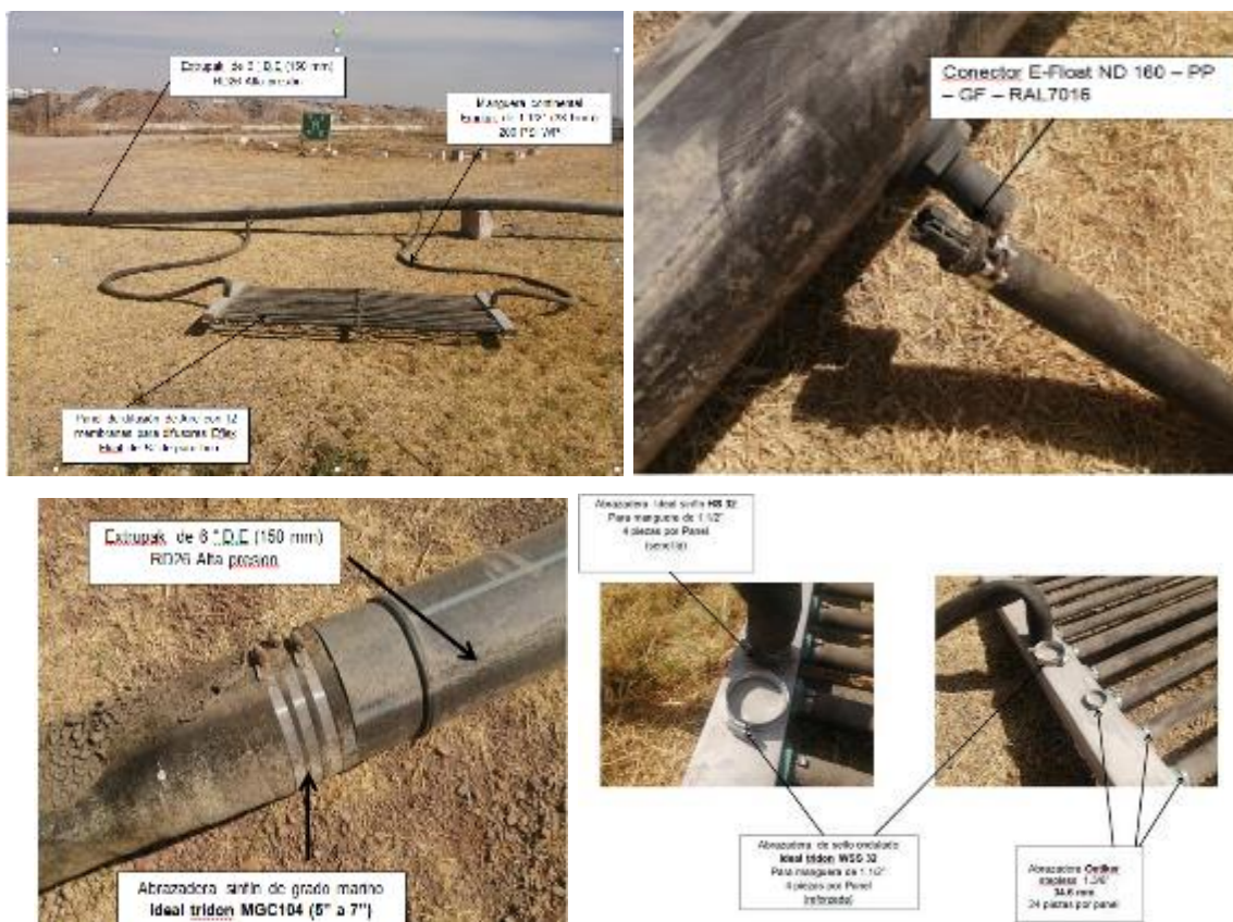
Figura 288. Sistema de aireación para las lagunas
