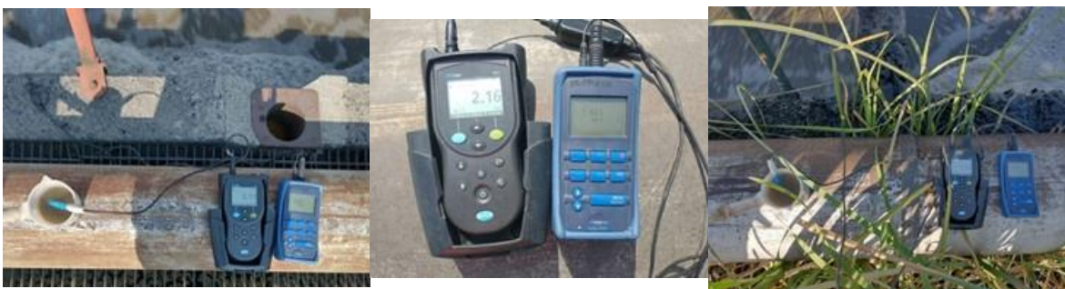
Figura 57 Equipos para la medición de pH y OD y determinaciones en campo
