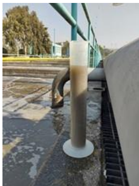
Figura 53 Lodos en prueba de sedimentación Unidad II, reactores 5-8
