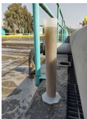
Figura 53 Lodos en prueba de sedimentación Unidad II, reactores 5-8
