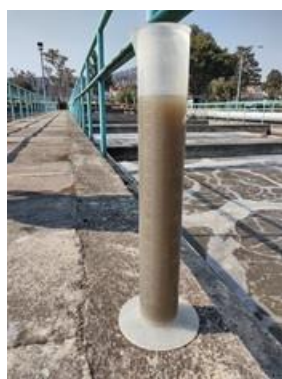
Figura 53 Lodos en prueba de sedimentación Unidad II, reactores 5-8
