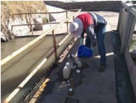
Punto de muestreo 2 - salida de rejillas finas (sección de pretratamiento)
