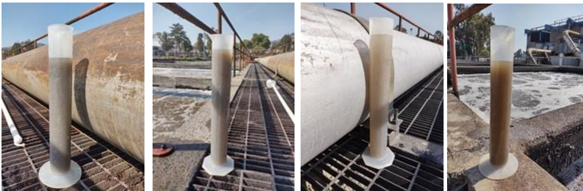
Figura 52 Lodos en prueba de sedimentación Unidad I, reactores 1-4
