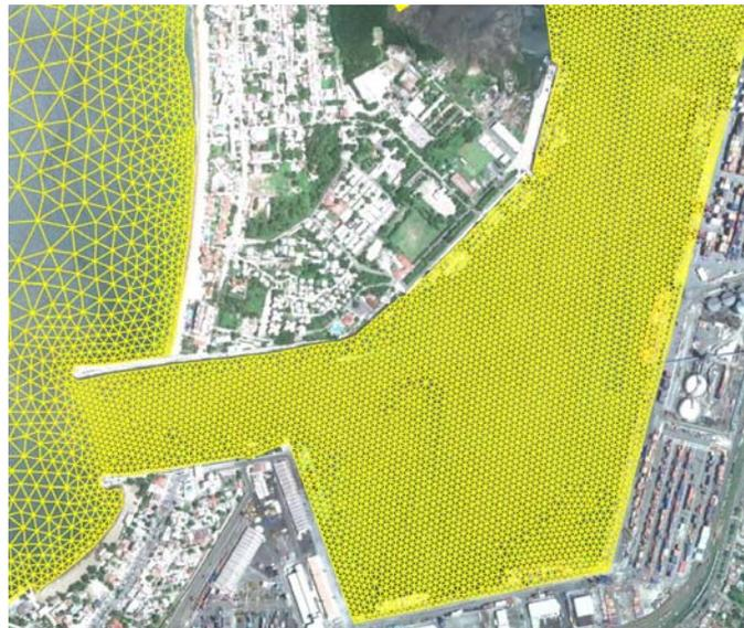
Figura 4.3 Detalle de la malla en el canal del puerto de Manzanillo.
