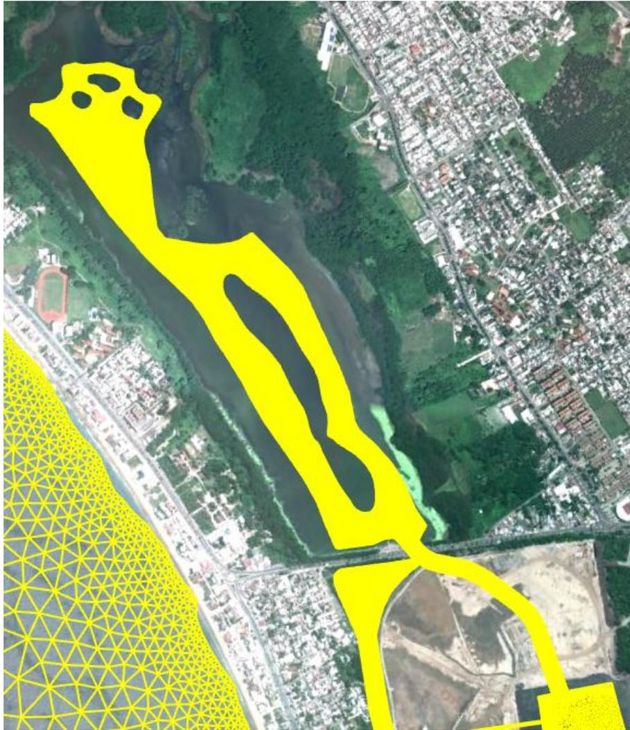
Figura 4.4 Detalle de la malla en la Laguna de las Garzas.
