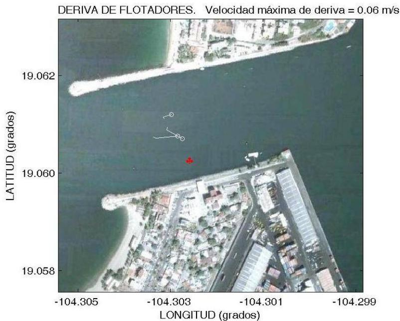
Figura 3.13 Experimento 2 de deriva de flotadores. 26/mayo/2010.
