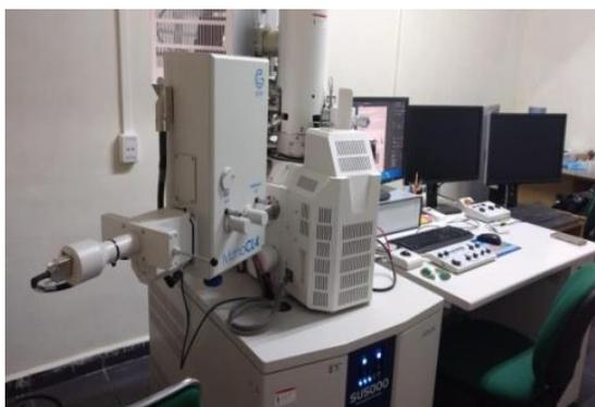
**Figura 28.** FE-SEM utilizado en la caracterización de las películas nanotubulares de trabajo.
