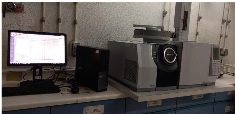
**Figura 19.** Cromatógrafo de gases utilizado en la cuantificación de los CF estudiados.
