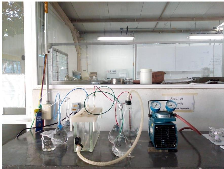
**Figura 67.** Proceso de extracción en fase solida
