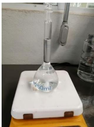
**Figura 76.** Agitación de la solución de metoprolol con una concentración de  $5 \mu\text{g L}^{-1}$ .
