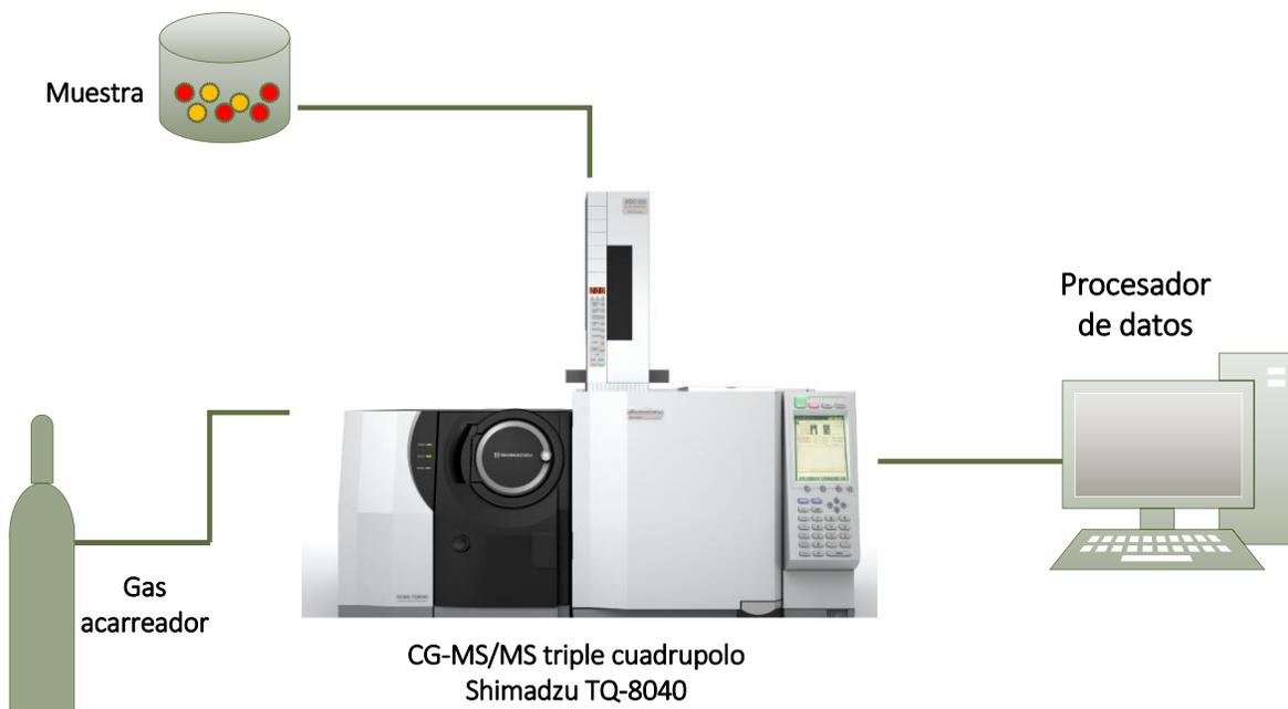
**Figura 20.** Esquema de los componentes principales que integran el sistema de CG-MS/MS utilizado en la determinación de los fármacos.
