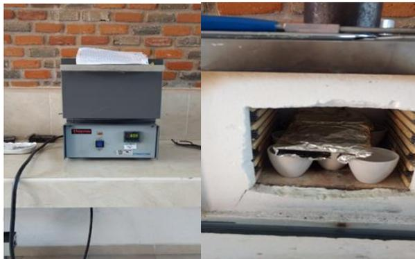
**Figura 27.** Tratamiento térmico. a) Mufla, b) placas sintetizadas dentro de la mufla.
