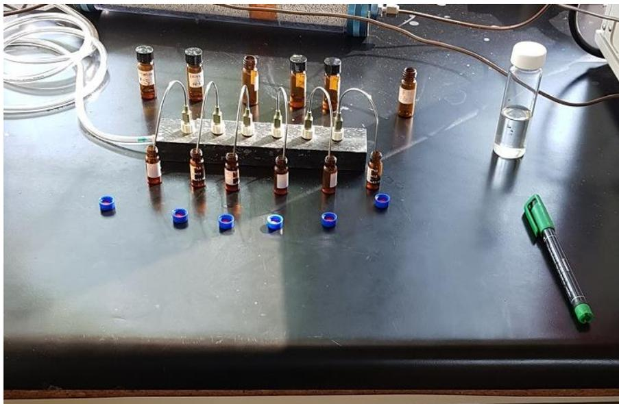
**Figura 68.** Proceso de evaporación mediante nitrógeno de alta pureza
