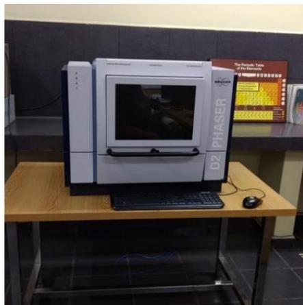
**Figura 29.** Difractómetro utilizado en el análisis de las fases cristalinas.
