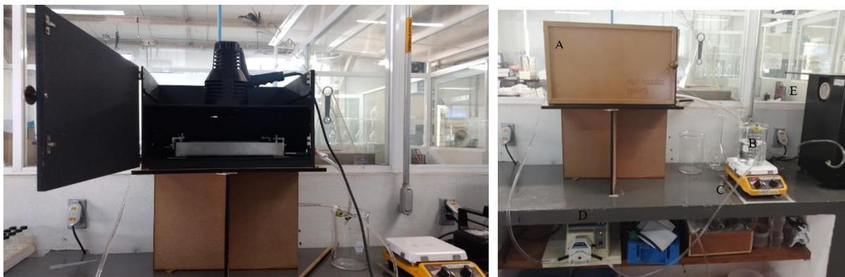
**Figura 75.** Sistema experimental: A) Caja negra, la cual en el interior contiene el Reactor Fotocatalítico (RF), B) Vaso de precipitados de 3 L, C) Parrilla de agitación, D) Bomba peristáltica (Master flex, modelo 07591-00), E) Concentrador de oxígeno marca Aeroflux.
