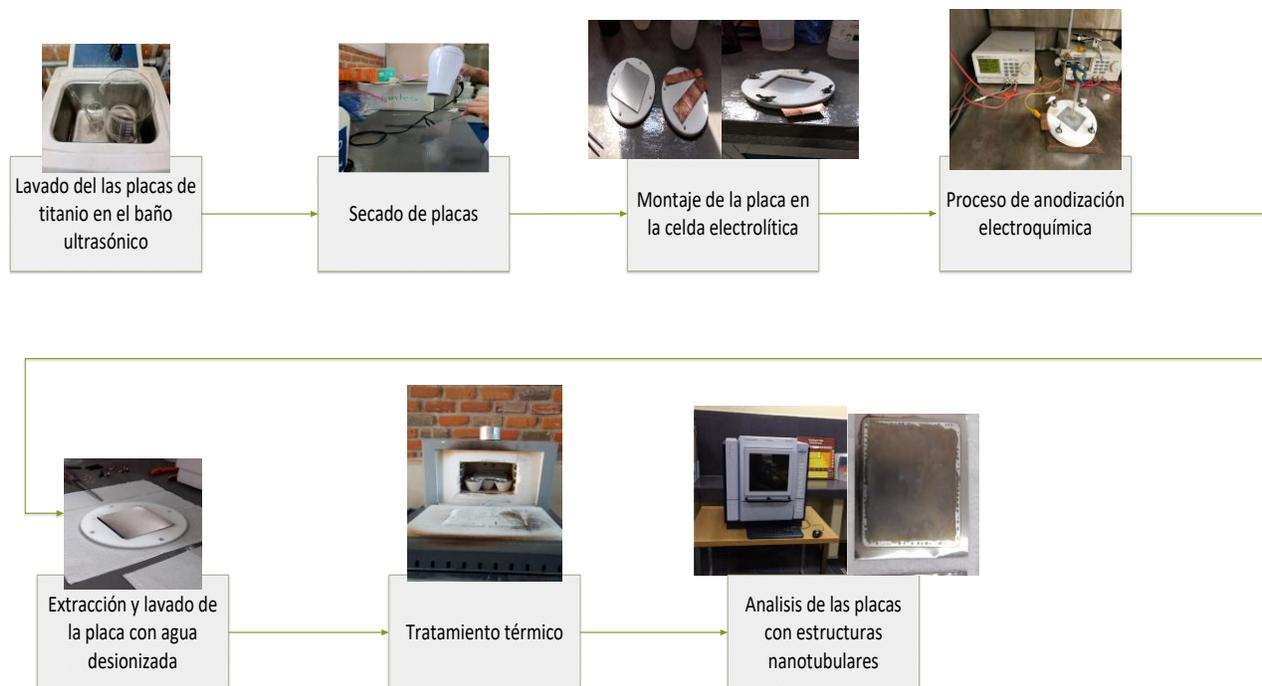
**Figura 30.** Metodología de la técnica de anodización electroquímica y análisis de las placas de nanotubos de  $\text{TiO}_2$ .
