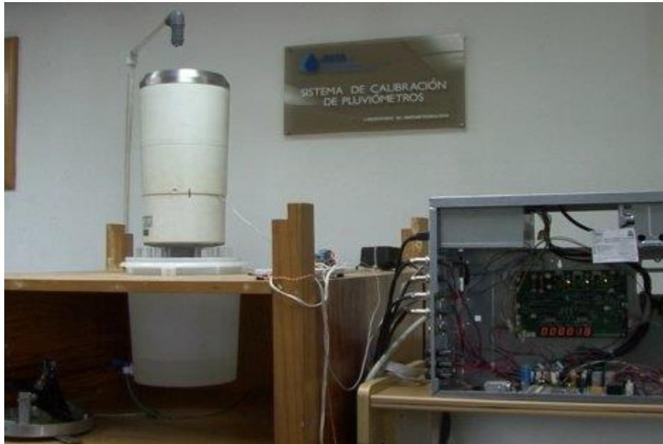
Figura 28.- Sistema de calibración de pluviómetros (Laboratorio de Calibración de sensores meteorológicos, IMTA)
