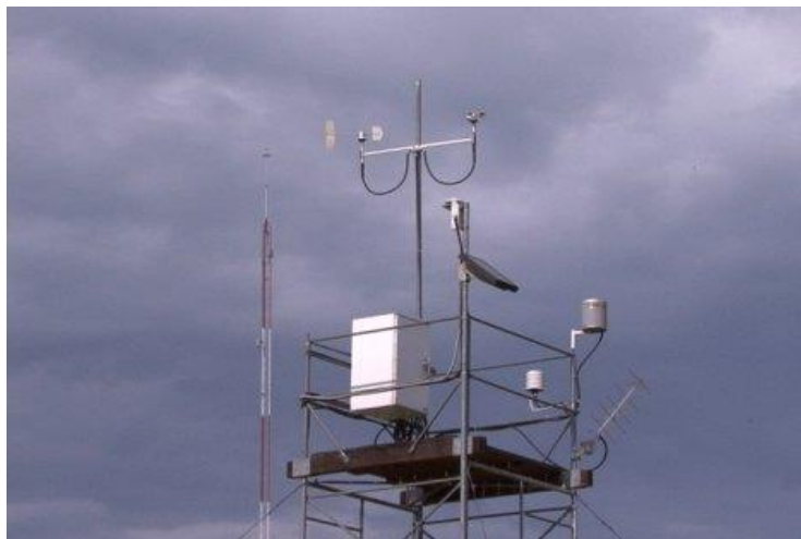
Figura 27.- Estación meteorológica automática en el IMTA (perteneciente a la red de estaciones del SMN)
