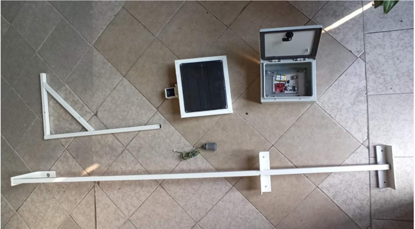
Ilustración 8.9 Sistema de monitoreo de nivel para el punto 3 (Ticuman) instalado en el IMTA
