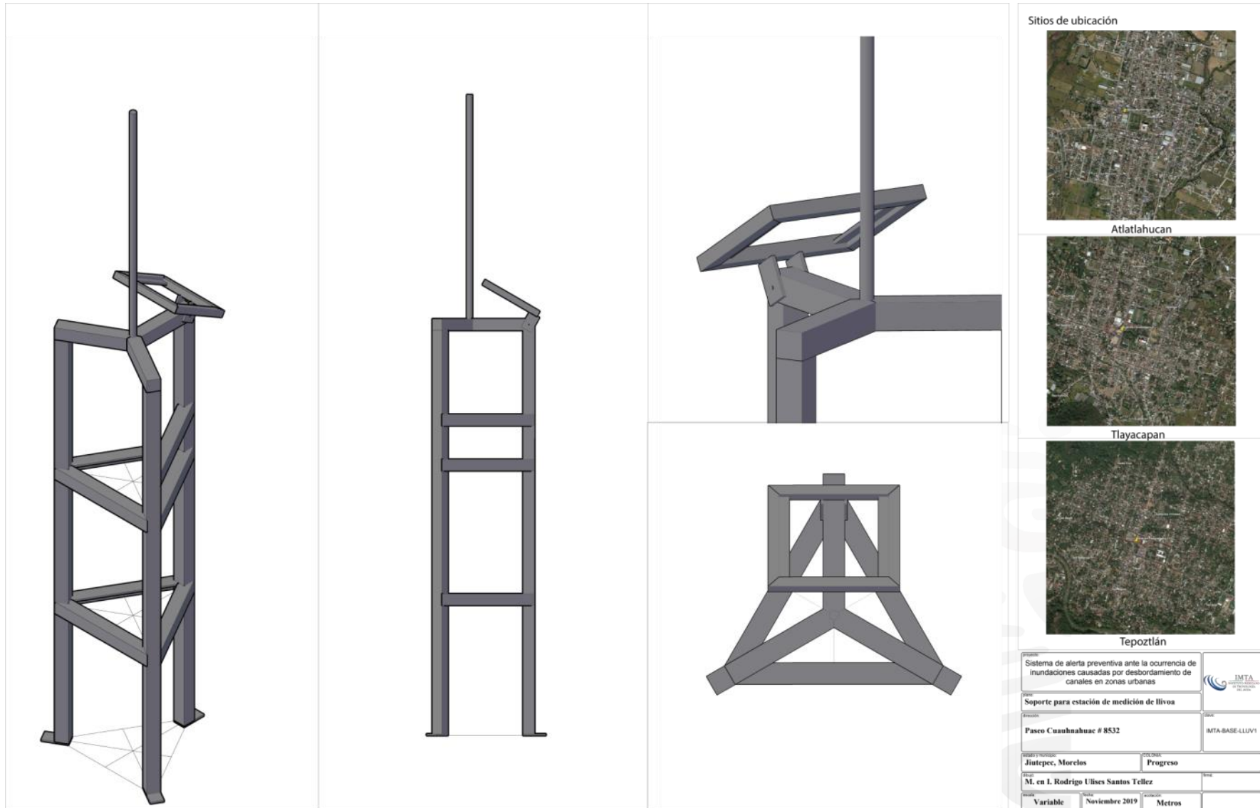
Ilustración 6.8 Plano del sistema de monitoreo de lluvia
