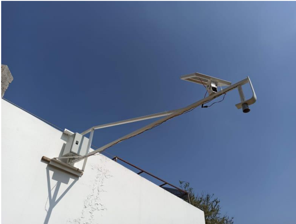
Ilustración 8.7 Sistema de monitoreo de nivel para el punto 1 (Oaxtepec) instalado en el IMTA
