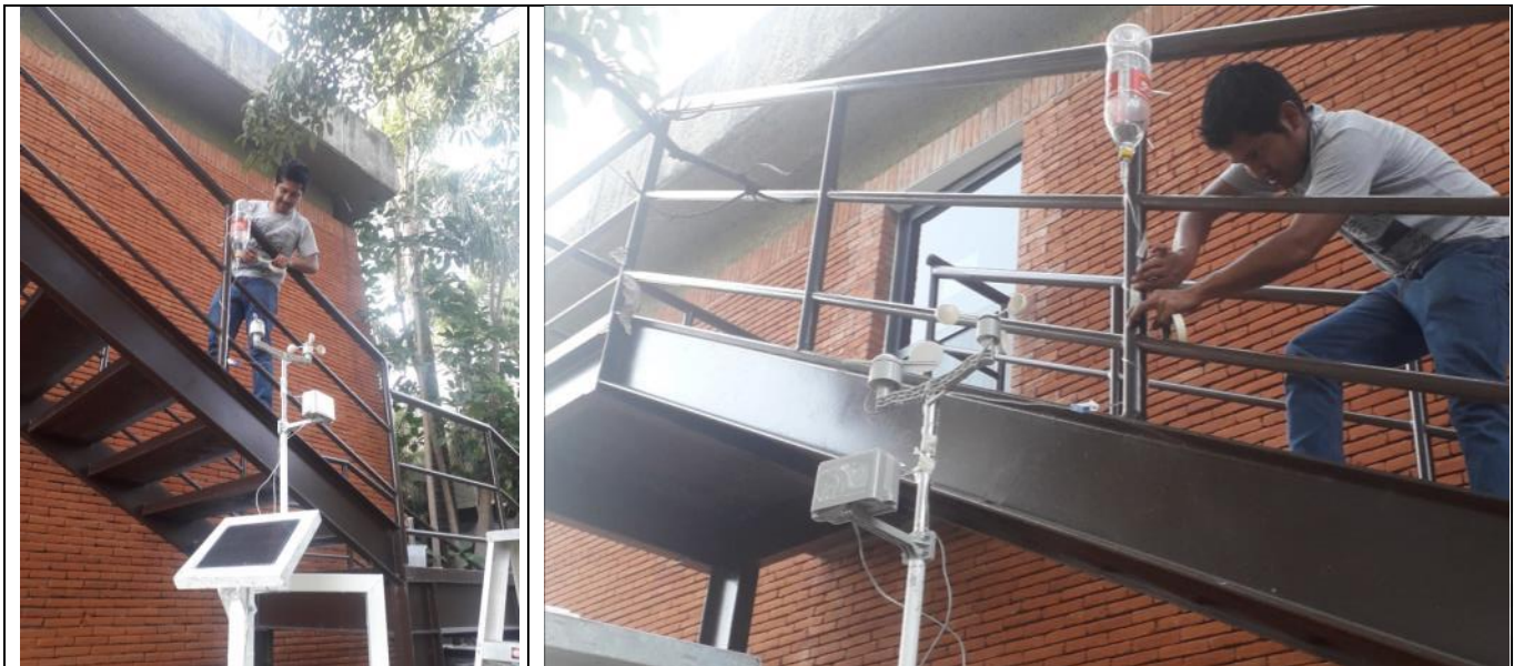
Ilustración 8.3 Sistema de verificación del funcionamiento del pluviómetro para el volumen de 250 ml
