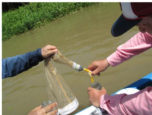
Figura 7. Red de arrastre para fitoplancton para análisis cuantitativo.
