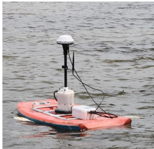
Figura 6. Perfilador Doppler montado en sistema de flotación con sus accesorios.
