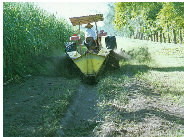
Figura 2.3 Drenaje superficial parcelario con zanjeadora tipo Dondi
