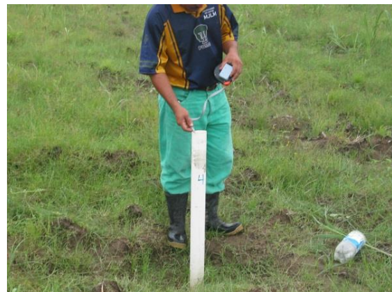
Figura 3.2 Medición de carga hidráulica
