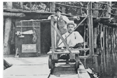
Figura 2.44 Molinete pequeño de Edwin Geary Paul, 1892; e instalaciones de calibración.
