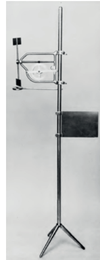
Figura 2.29 Replica del molinete de Woltman, 1790.
