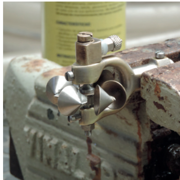
Figura 4.2 Revisión del giro de la rueda de copas en un molinete “pigmeo”.
