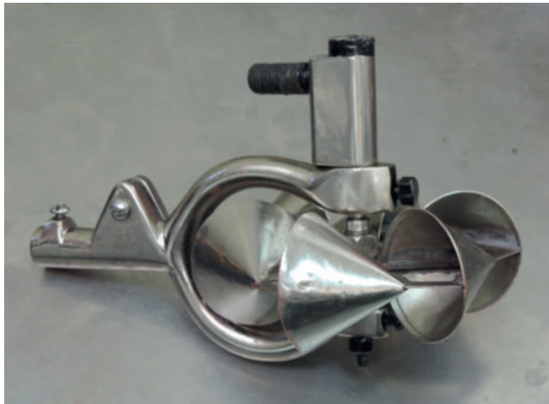
Figura 3.15 Molinete con cámara de contactos de funcionamiento magnético
