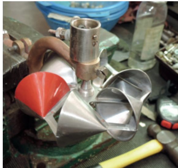
Figura 3.21 Rueda de copas con una de ellas pintada para conteo visual directo
