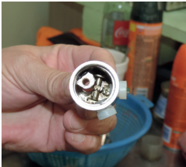
Figura 3.14 Vista del interior de la cámara de contactos
