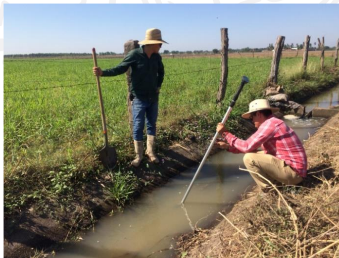
Figura 10. Medición del gasto de entrada
