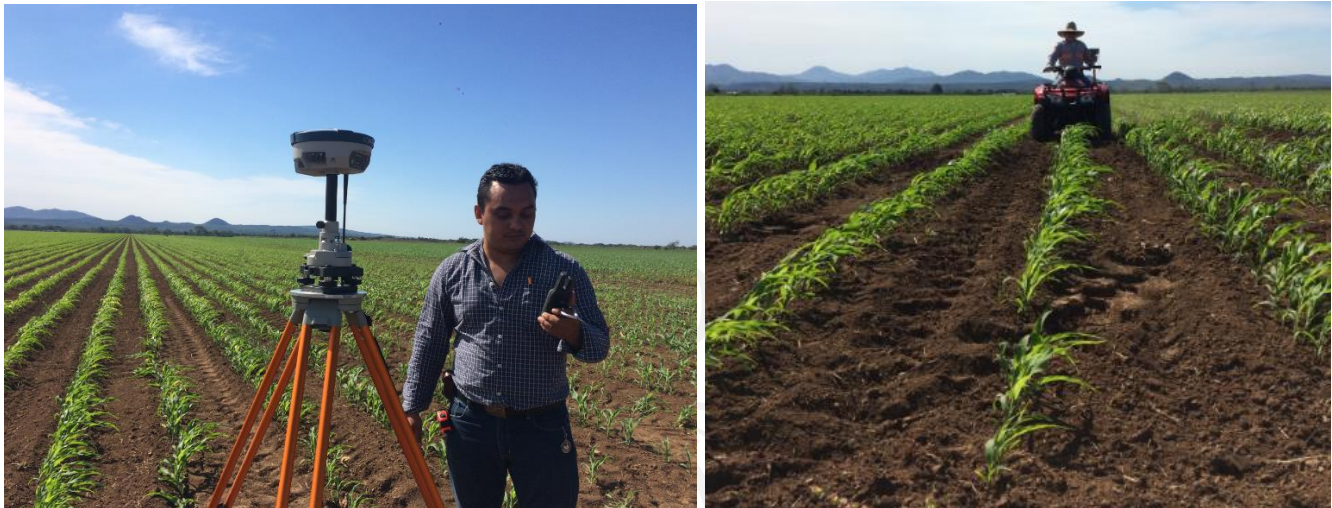
Figura 7. Equipo utilizado durante el levantamiento topográfico
