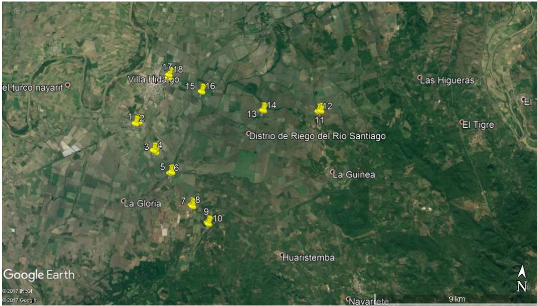
Figura 19. Red de puntos colocados de la Red Geodésica Nacional
