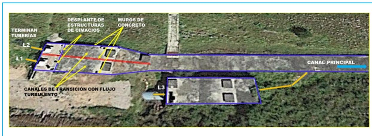
Ilustración 5.250 Llegada de las líneas L2, L1 y L3 del Sistema Cutzamala al Portal de entrada Túnel Analco
