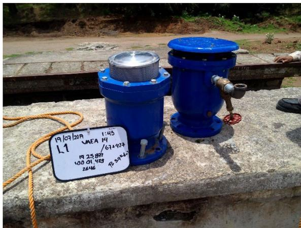
Vista de ambas VAEAs: la VAEA del sitio y la VAEA con el arreglo para instalar manómetro
