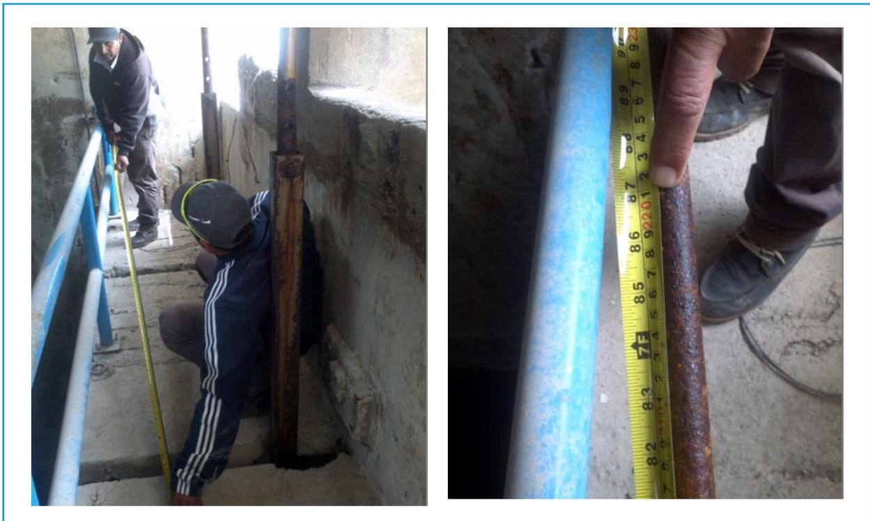
Ilustración 5.220 Medición de la profundidad del agua en el Tanque Santa Isabel
