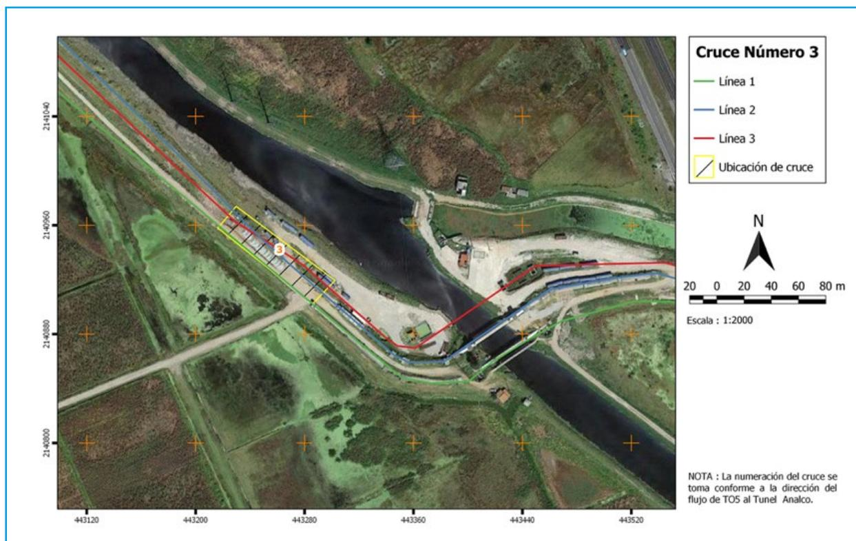
Ilustración 5.238 Ubicación del tercer cruce la L3 cambia al lado izquierdo de la L2, la cual va al centro
