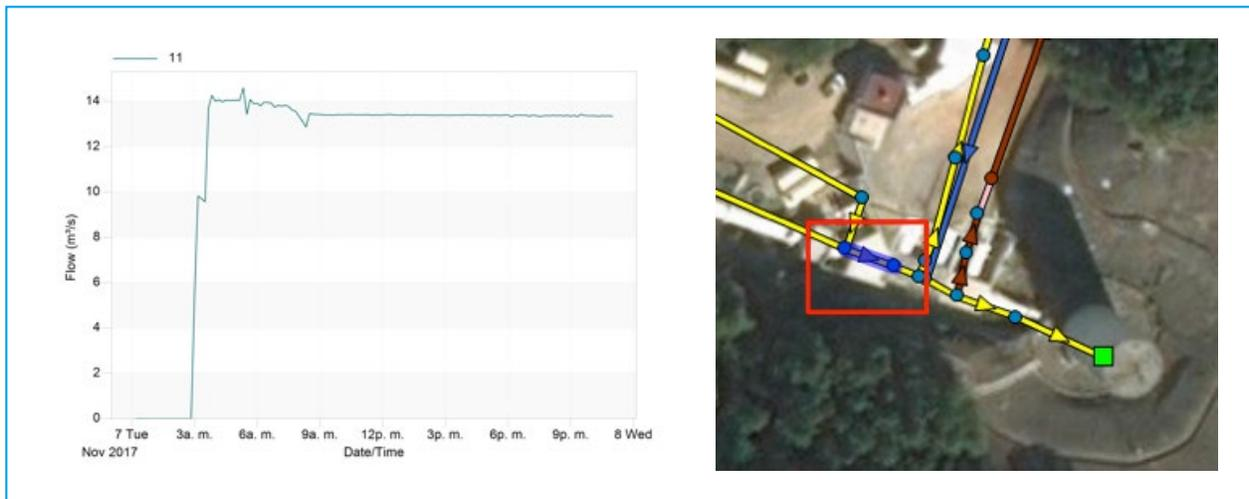
Ilustración 5.15 Gasto previo a la descarga previo a conducirse por la línea 1 y 2
