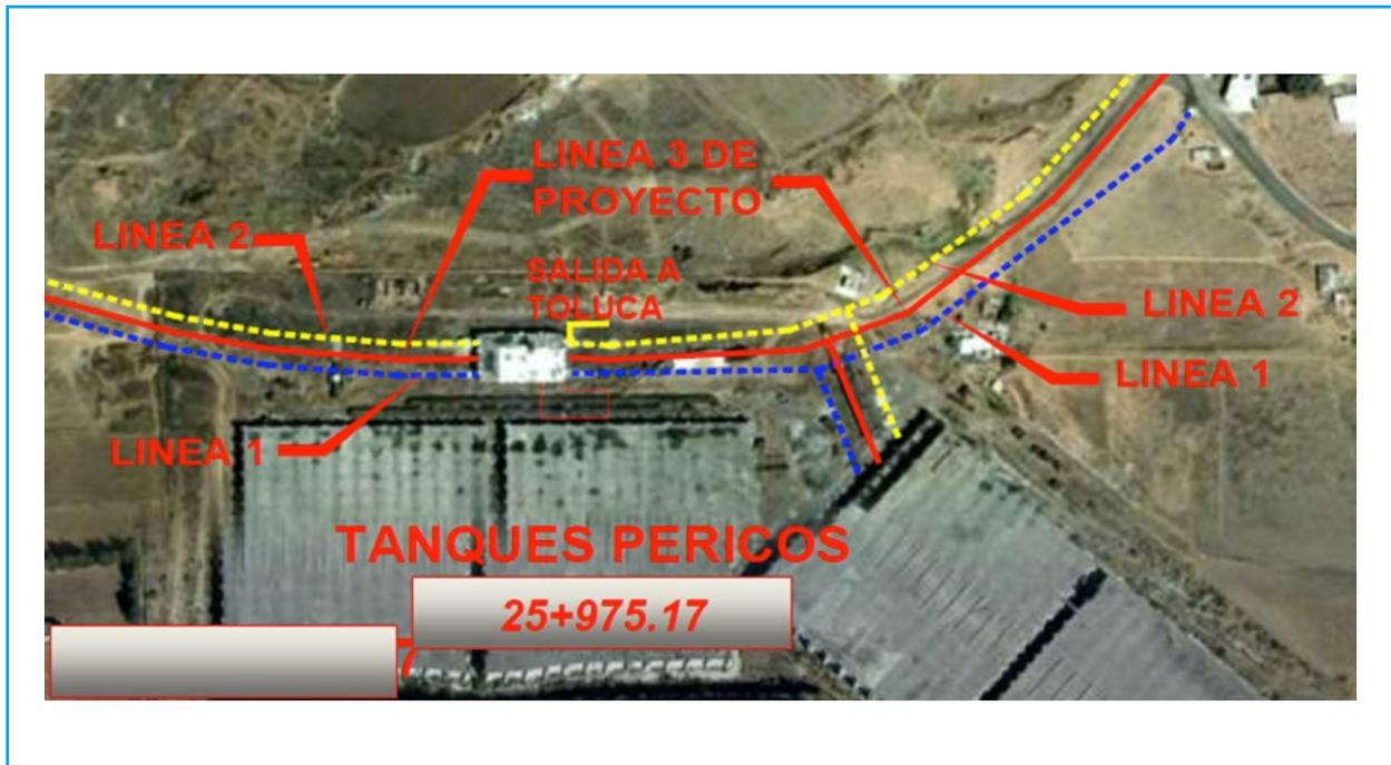
Ilustración 5.204 Tanque Pericos, llegada y salida de líneas de conducción
