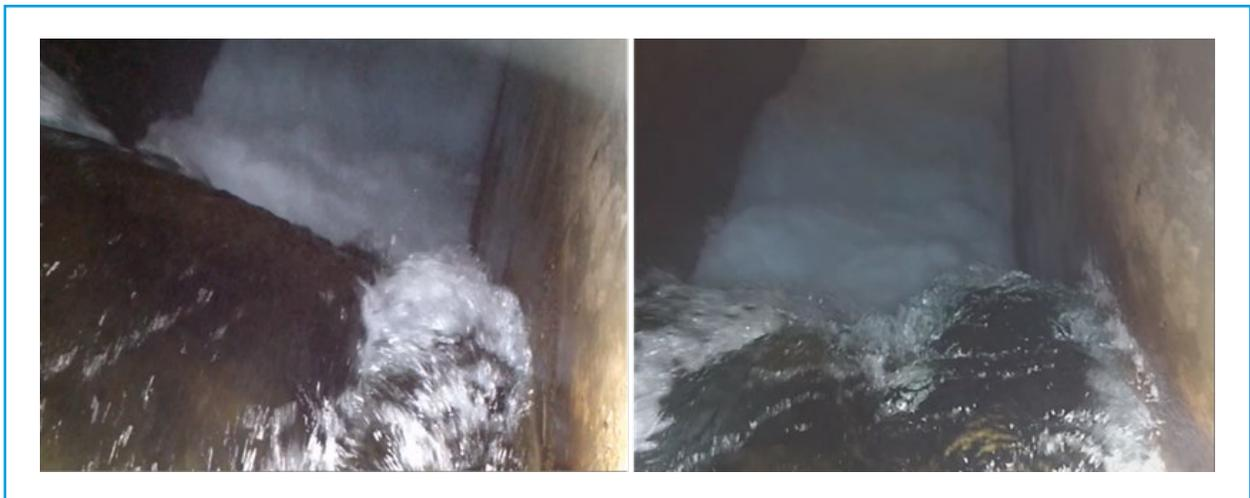
Ilustración 5.253 Flujo turbulento sobre la cresta del vertedor, en la caída al canal se genera mucha turbulencia
