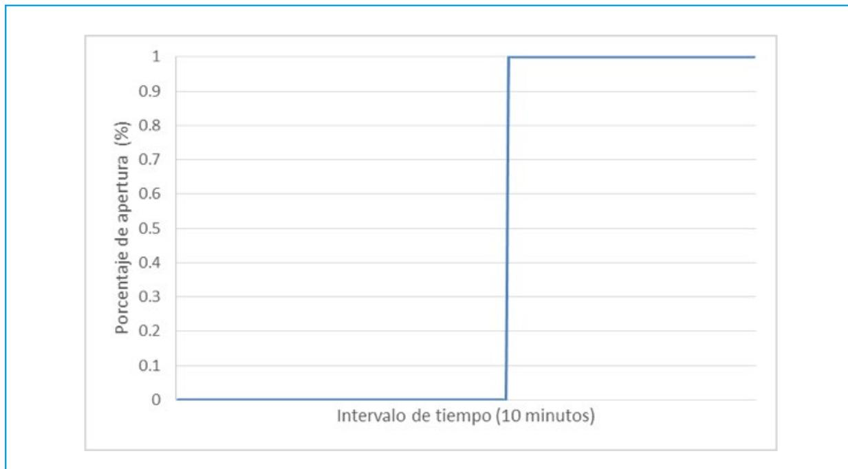
Ilustración 5.99 Porcentaje de apertura de la válvula de regulación
