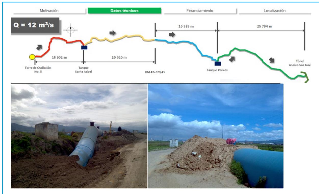
Ilustración 5.216 Datos generales de la Línea 3 en Construcción
