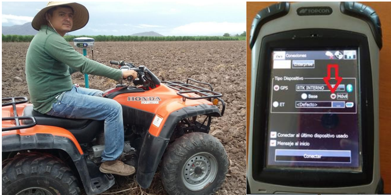
Figura 11. Recorrido por la parcela para la recolección de puntos topográficos del terreno.
