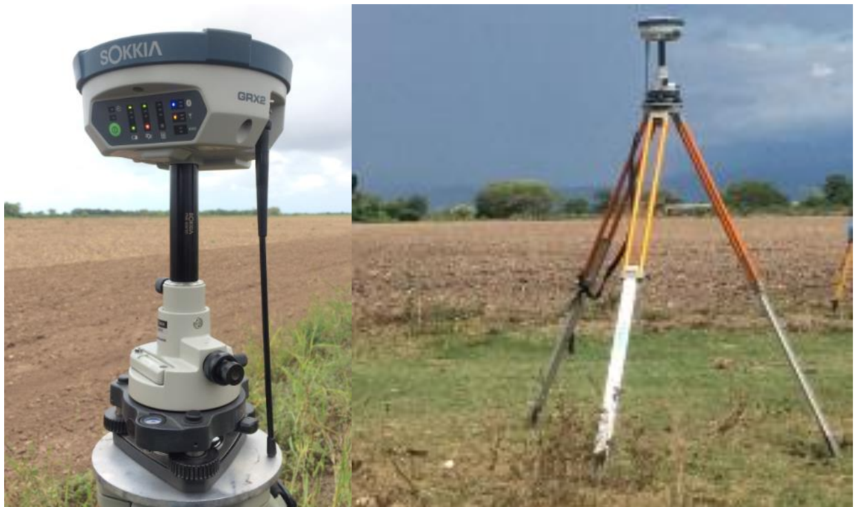
Figura 10. GPS diferencial con tecnología RTK de la marca SOKKIA, modelo GRX2.
