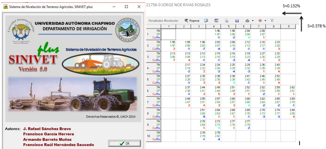
Figura 13. Diseño de proyectos de nivelación con el programa SINIVET.
