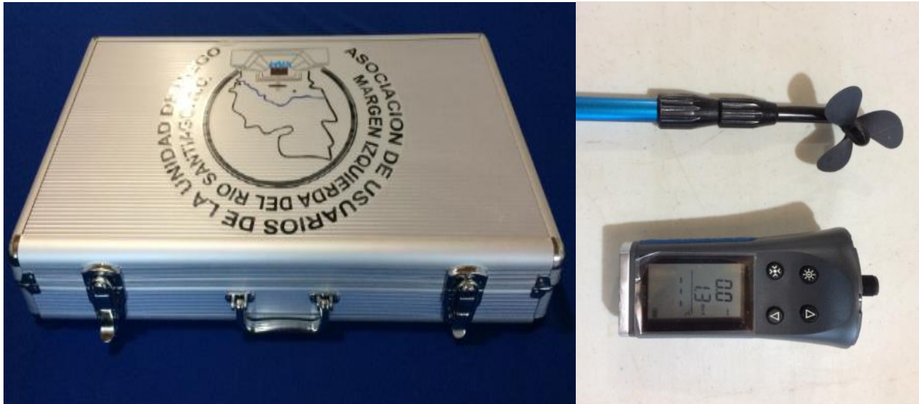
Figura 34. Molinete digital utilizado para la medición del flujo de agua de riego a nivel parcelario.
