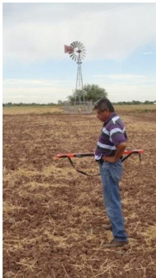
Figura 1. Monitorización de la salinidad con un sensor electromagnético EM-38 de Geonics Limited®.
