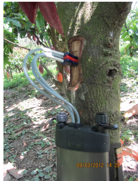
FIGURA 3. Sistema de pulso de calor con sensores y calentador insertados en el tallo de una planta de cacao.
