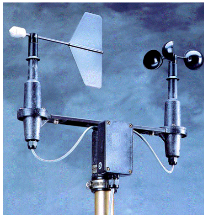
Figura 2.5 A). Veleta y anemómetro para medir dirección e intensidad del viento. B) Rosa de los vientos
