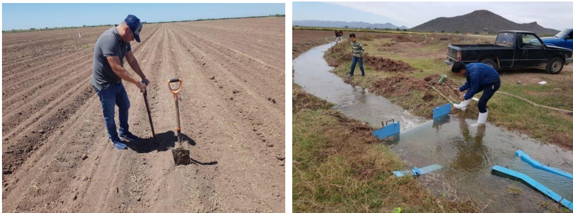
Figura 2.50 Determinación del contenido de humedad y aforo volumétrico en regadera
