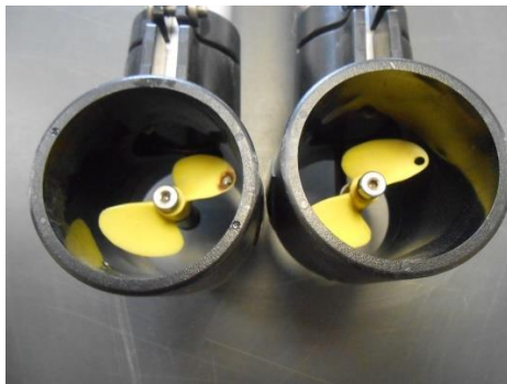
Figura 2.54 Medidor de hélice digital dañado y bueno en el Módulo 3
