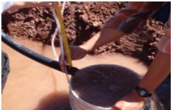
Figura 2.44 Método volumétrico para calibrar sifones de PVC para medición de gasto
