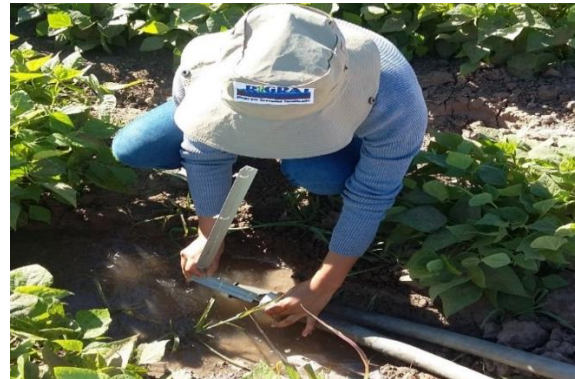
Figura 2.45 Medición del gasto con sifones de 1 1/2" PVC cultivo frijol O-I
