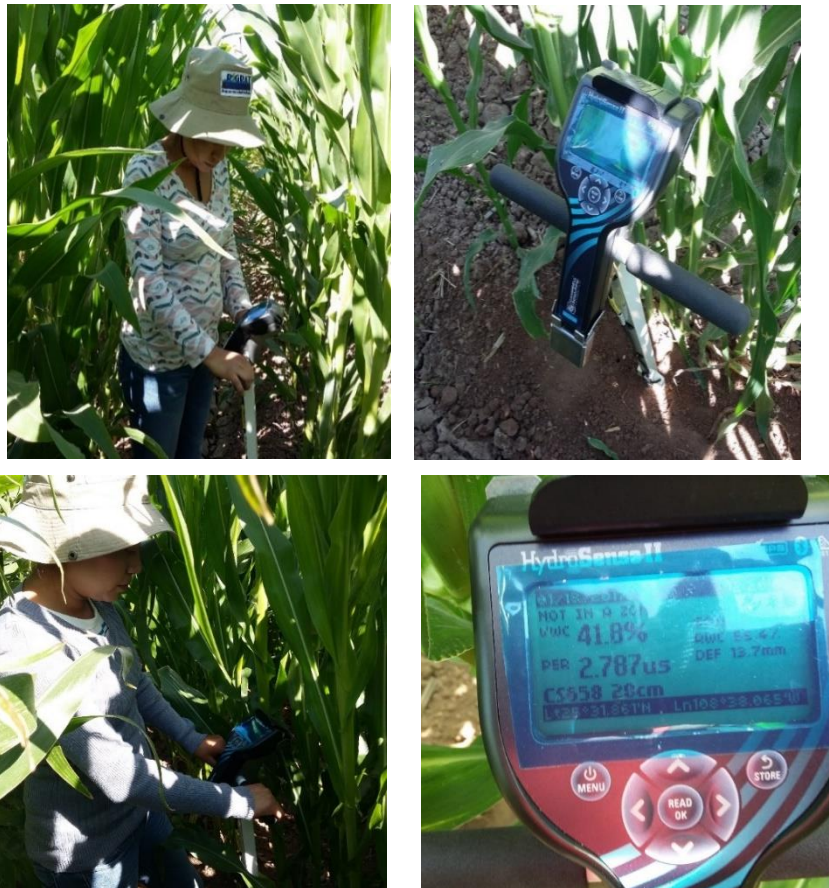
Figura 2.42 Monitoreo de humedad en campo (TDR)
