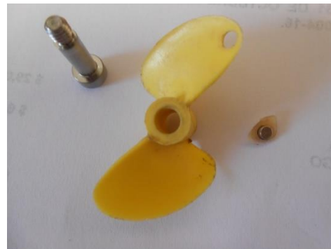
Figura 2.55 Hélice desensamblada de medidor digital dañado en el Módulo 3
