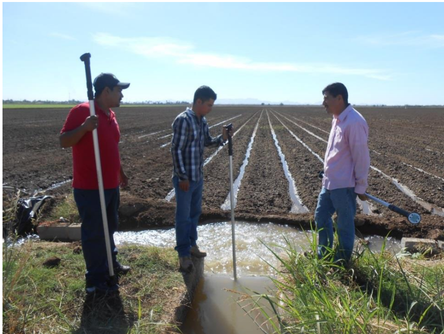
Figura 2.58 Verificación de medidor de hélice digital reparado y bueno en el Módulo.
