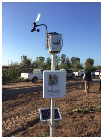
Figura 2.53 Estación meteorológica automatizada.
