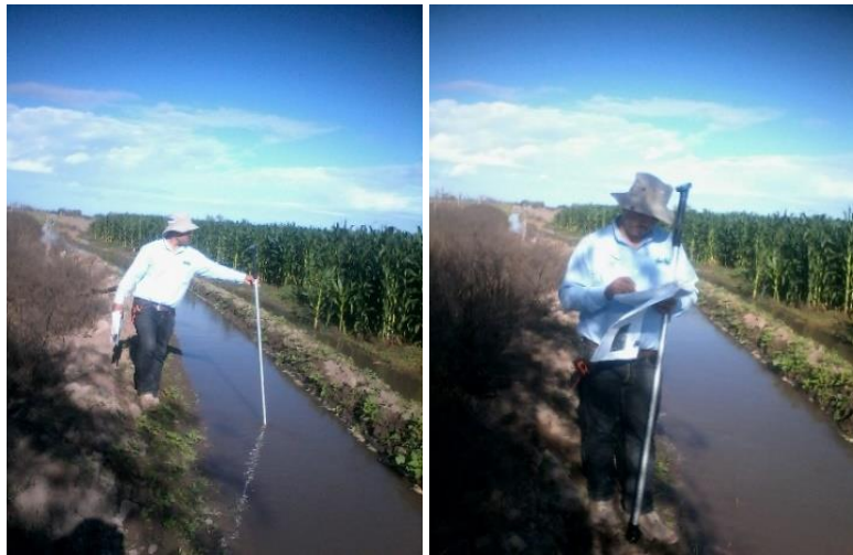
Figura 2.43 Aforo de canal interparcelaria con el medidor de flujo
