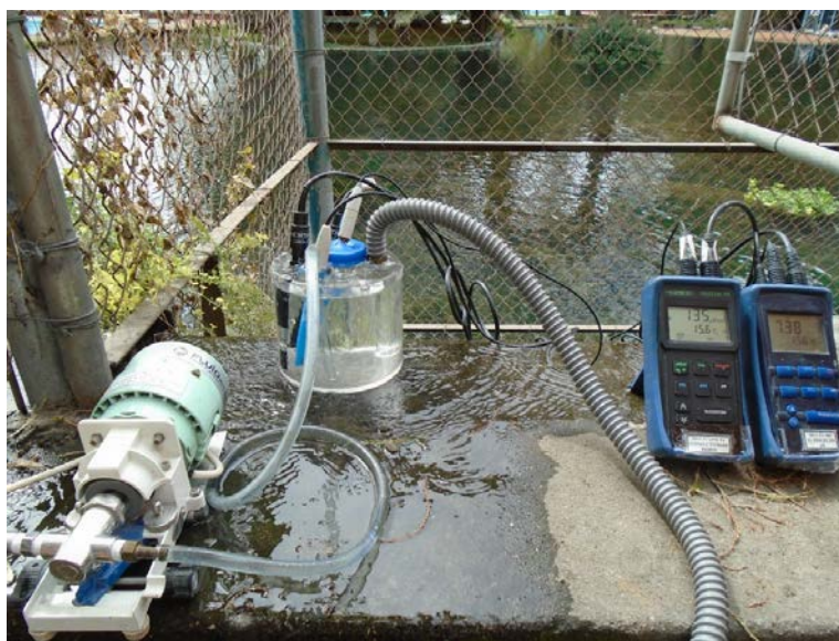
Figura 5.4 Medición de parámetros de campo con electrodos y equipos multiparamétricos, celda de aislamiento y bomba subacuática de flujo continuo regulado.
