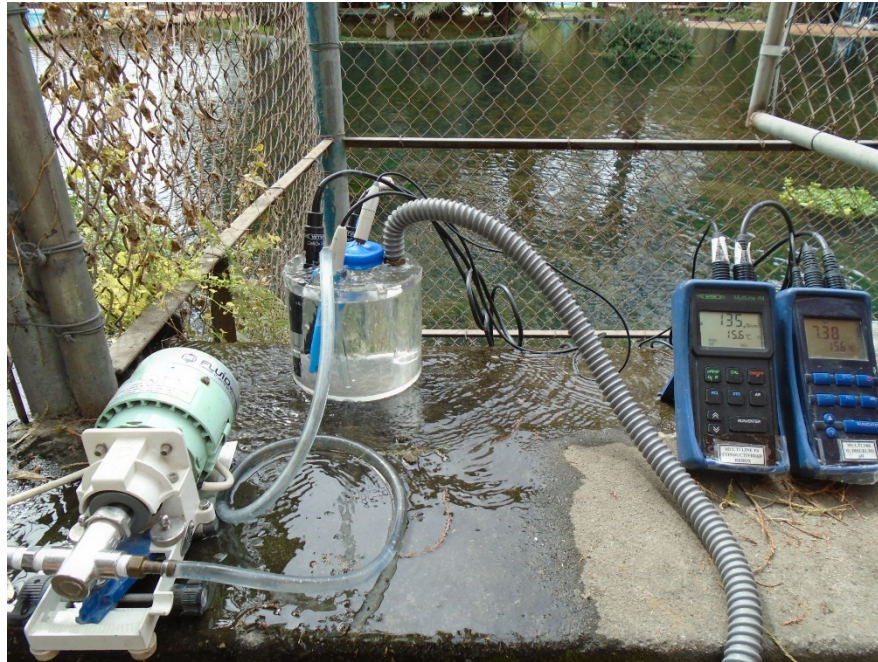
Figura 3.2 Medición de parámetros de campo con electrodos multiparamétricos y celda de aislamiento en el manantial Las Fuentes en el Estado de Morelos
