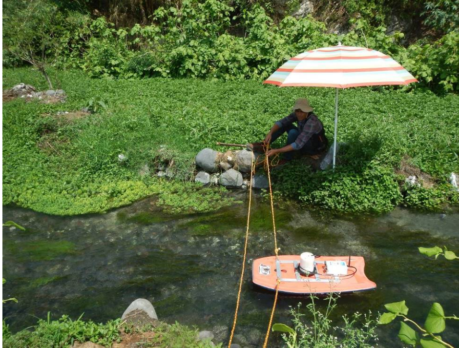
Figura 6.22 Aforo del manantial "Agua Azul" utilizando el equipo portátil perfilador Doppler
