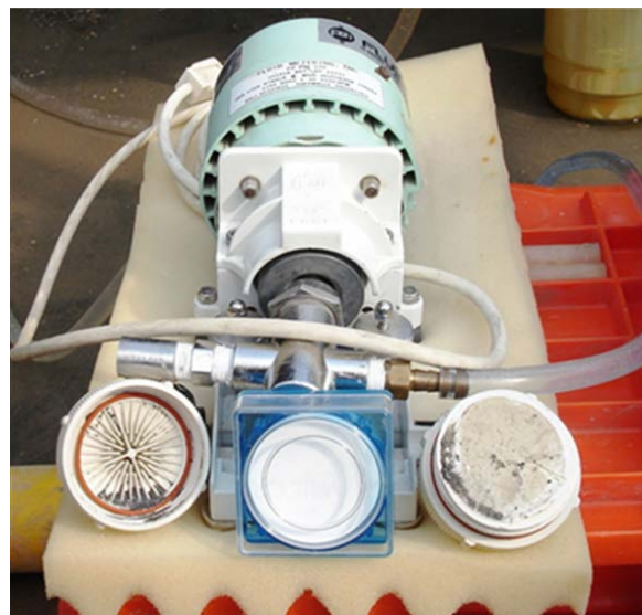
Figura 5.2 Filtrado de muestras de agua con membrana de celulosa de 0.45\mu a presión positiva.
