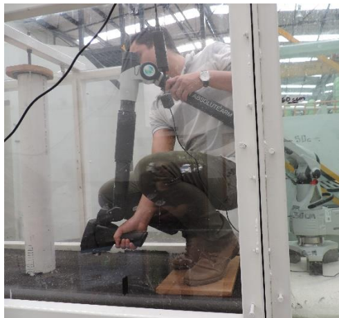
Fotografía. 15. Levantamiento del fondo de arena modificado por la socavación con un scanner tipo lidar
