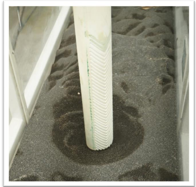
Fotografía. 18. Pila con rugosidad direccional, P3, colocada en el canal de socavación en forma recta y rotada 45° a la derecha
