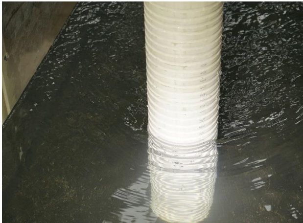
Fotografía. 19. Pila con rugosidad en anillos concéntricos. P5
