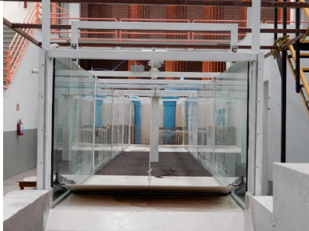
Fotografía. 11. Compuerta de control basculante para el control del tirante al final del canal de prueba.
