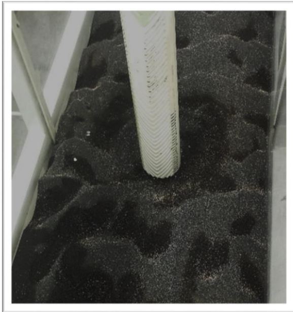
Fotografía. 18. Pila con rugosidad direccional, P3, colocada en el canal de socavación en forma recta y rotada 45° a la derecha
