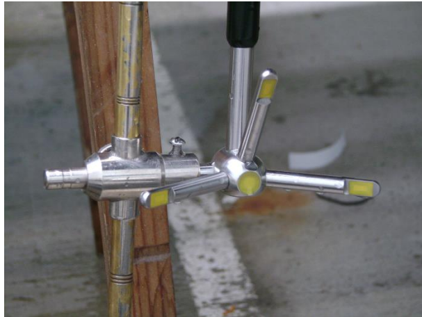
Fotografía. 13. Medidor de flujo FlowTracker .
