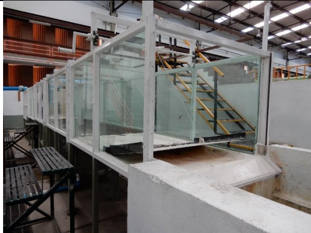
Fotografía. 9. Tramo aguas abajo. Canal de acondicionamiento del flujo a la salida
