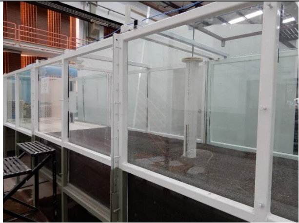
Fotografía. 8. Tramo de pruebas (intermedio). Depósito de arena para prueba de socavación de la pila
