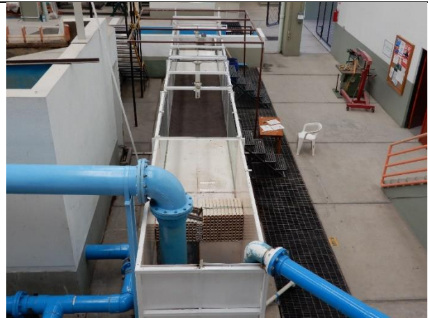
Fotografía. 6. Canal de prueba modificado de 120 cm de ancho por 11.28 metros de largo.
