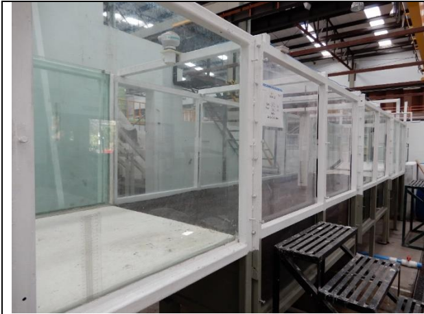
Fotografía. 7. Tramo aguas arriba. Tanque de alimentación y canal de acondicionamiento del flujo
