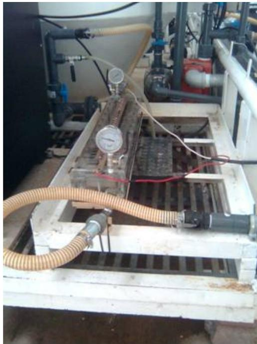
**Figura IV.4.2 Reactor de electrocoagulación**
