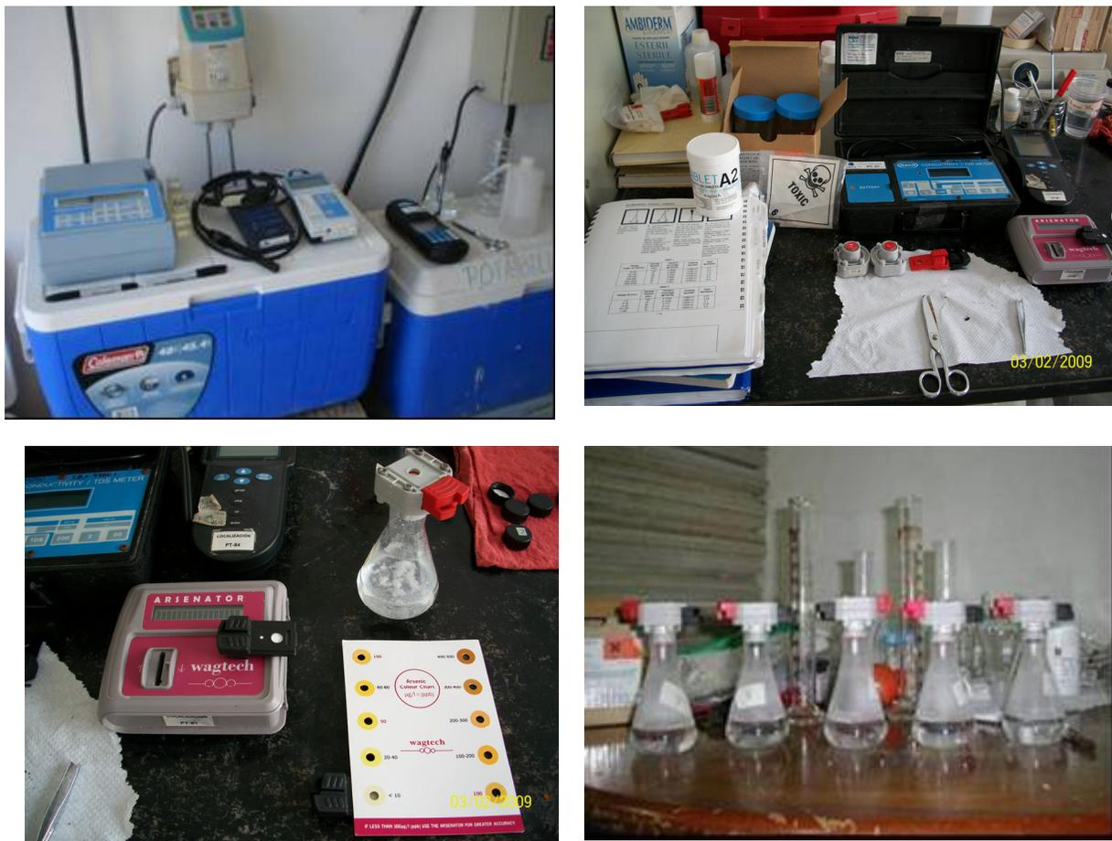
**Figura. IV.1 Equipos utilizados para las mediciones en campo: espectrofotómetro Hach, potenciómetro, conductímetro, fotómetro Arsenator y erlenmeyers de reacción (Arsenator).**
