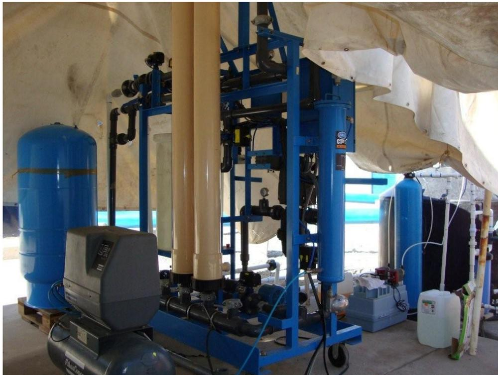
**Figura IV.5.2 Instalación del piloto de microfiltración asistida por coagulación en el pozo 32R (Torreón)**
