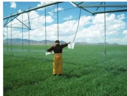
Ilustración 11. Pivote central (movimiento continuo).
