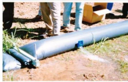
Ilustración 5. Tubería multicompuertas de PEBD.
