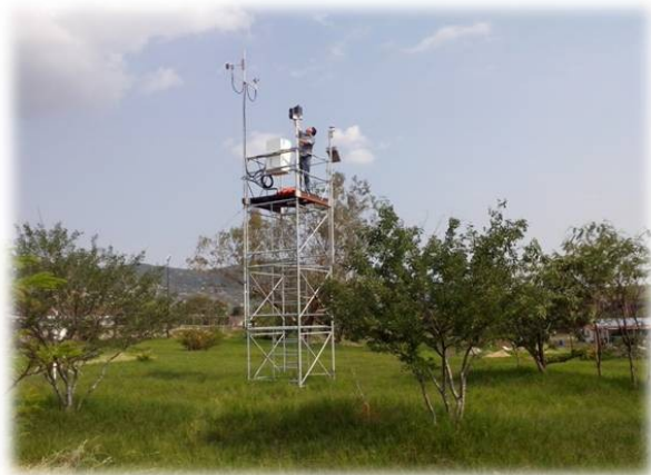
Fig. 6.2 IDDC integrada a una estación climatológica convencional
