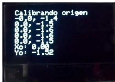
Figura 3.1 Pantalla de calibración del nivel electrónico para conjunto prisma-baliza
