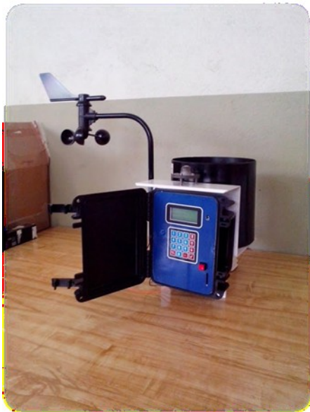
Fig. 6.2 IDDC integrada a una estación climatológica convencional
