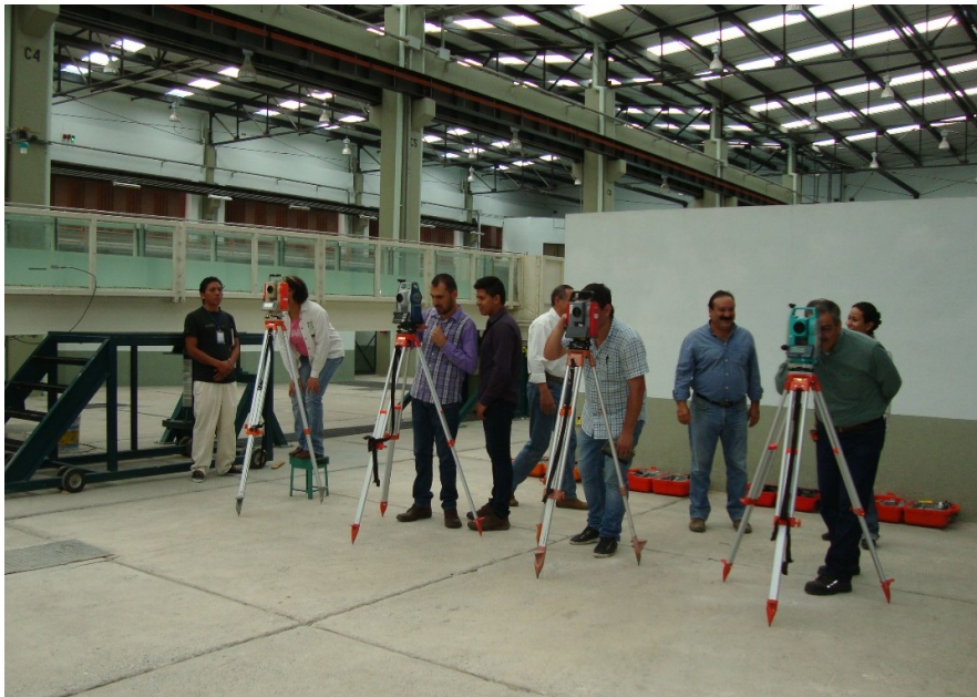
Fotografía 4. Pruebas en laboratorio para el establecimiento de la metodología adecuada de uso de estación total para medición de testigos superficiales
