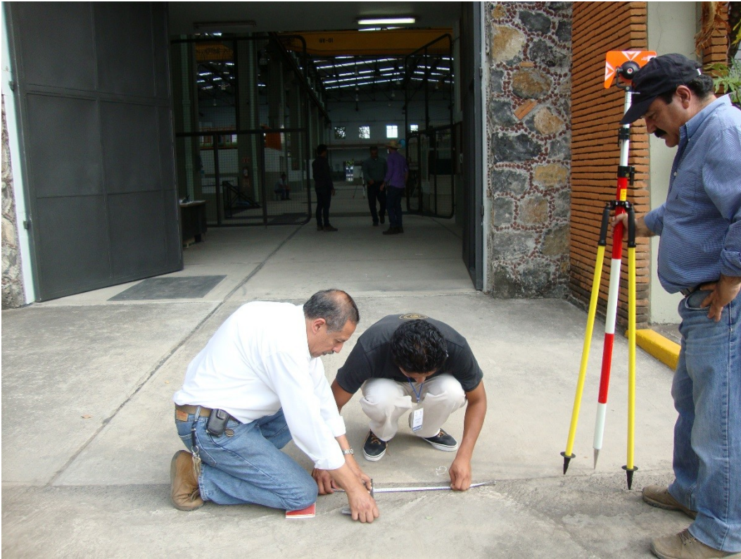
Fotografía 5. Pruebas en laboratorio para el establecimiento de la metodología adecuada de uso de estación total para medición de testigos superficiales
