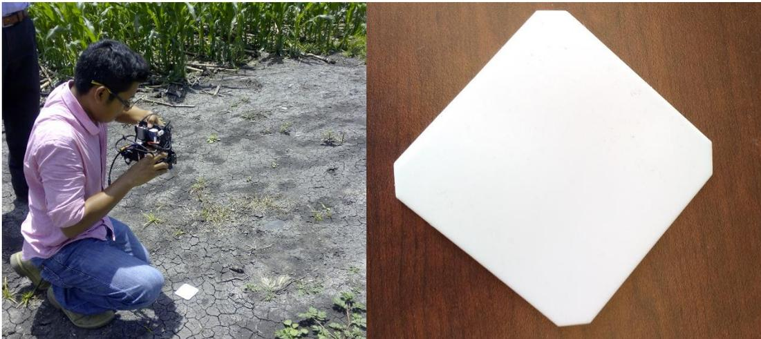
**Figura 26.** Espectralón empleado para la corrección radiométrica.
