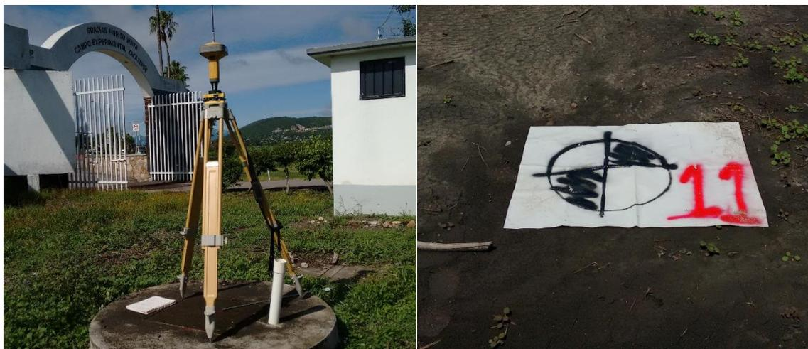
**Figura 23.** Ubicación del punto base (izquierda) y marca de un punto de control en el terreno (derecha).
