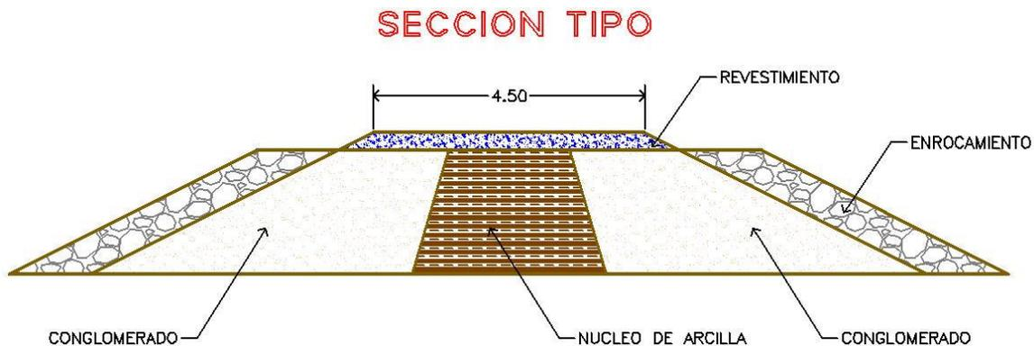
Figura 5.20 Sección transversal del muro propuesto.
