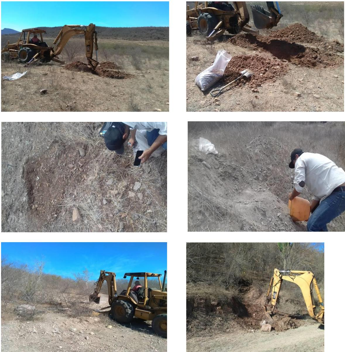
Figura 4.9 Fotos del muestreo Banco Hermes en la margen izquierda del CPH.
