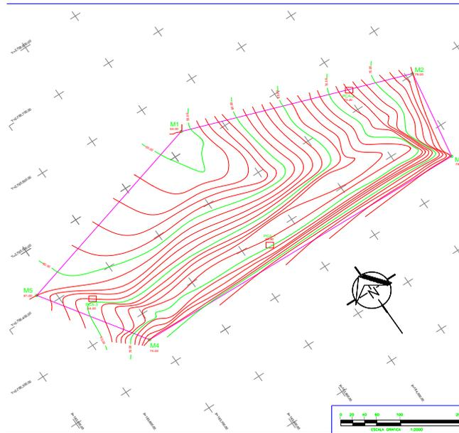
Figura 4.18 Levantamiento topográfico del Banco para revestimiento de caminos “Cerro Bola”.
