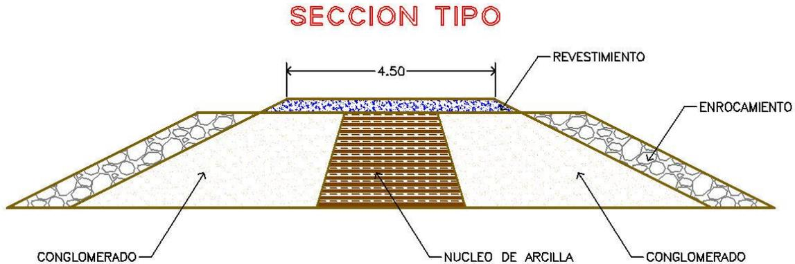
Figura 5.18 Bordo de protección con materiales graduados del km 0+000 al km 0+620.
