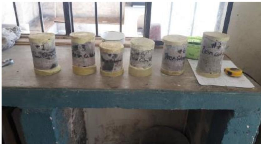
Figura 1.24 Núcleos de concreto cabeceados con azufre.
