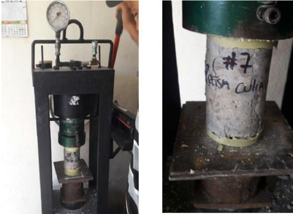
Figura 1.26 Momento de falla en núcleo de prueba No. 7.
