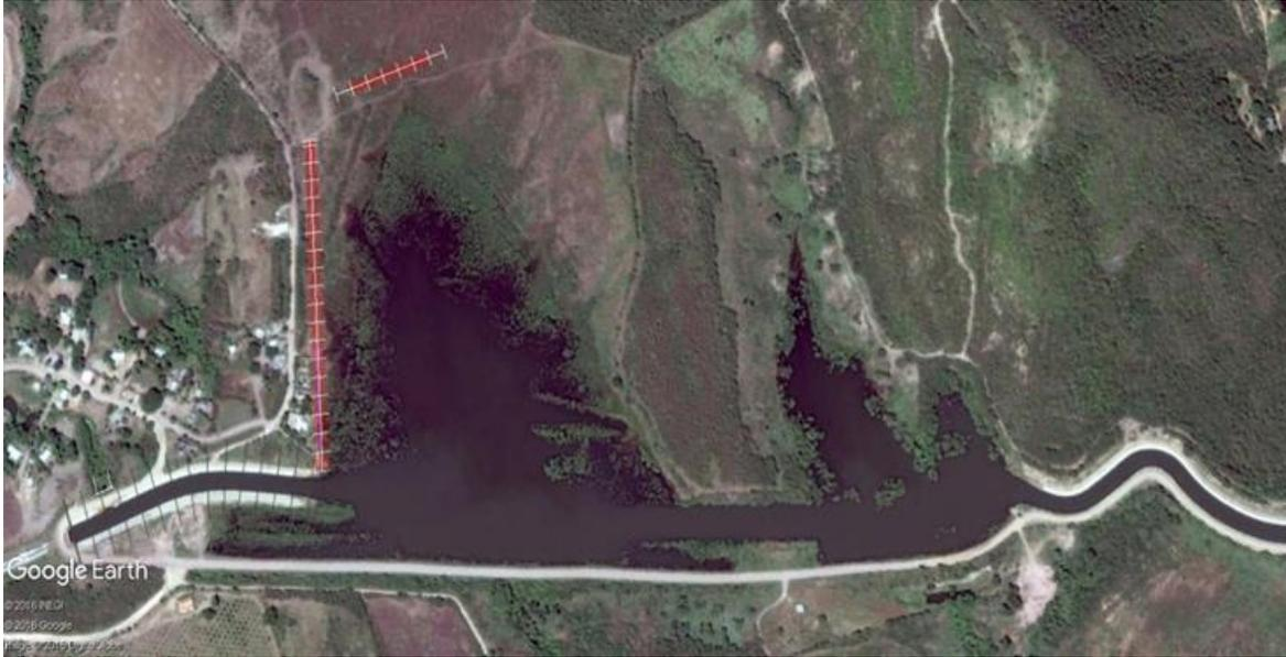
Figura 5.15 Trazo de la trinchera de arcilla de protección.
