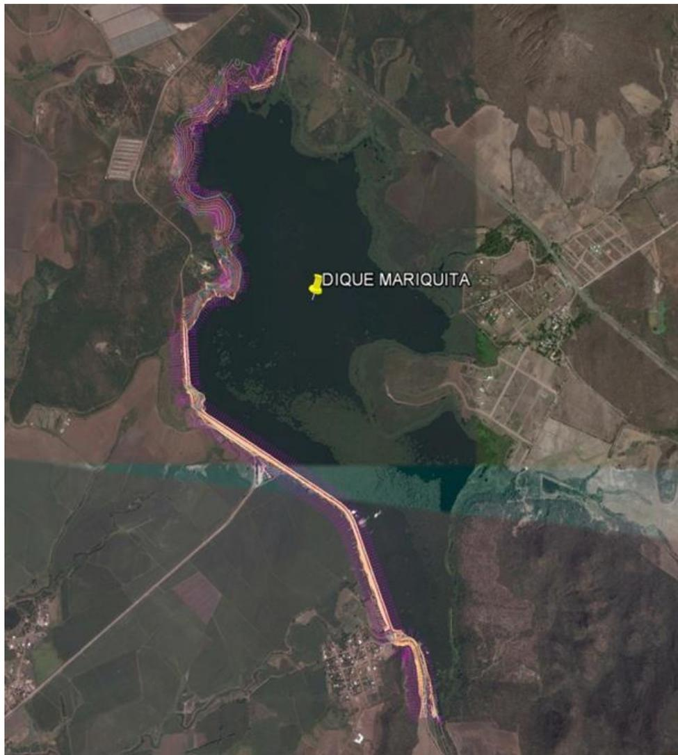
Figura 5.36 Proyecto ejecutivo de sobreelevación del Dique Mariquita en su margen izquierda realizado por el IMTA en el año 2016.
