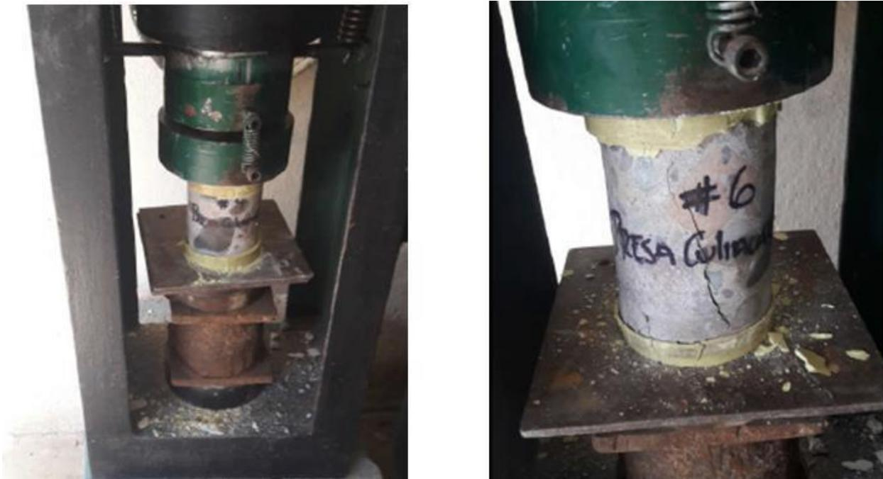
Figura 1.25 Prueba de compresión simple aplicada a los núcleos de concreto y falla longitudinal de una de los corazones de concreto.
