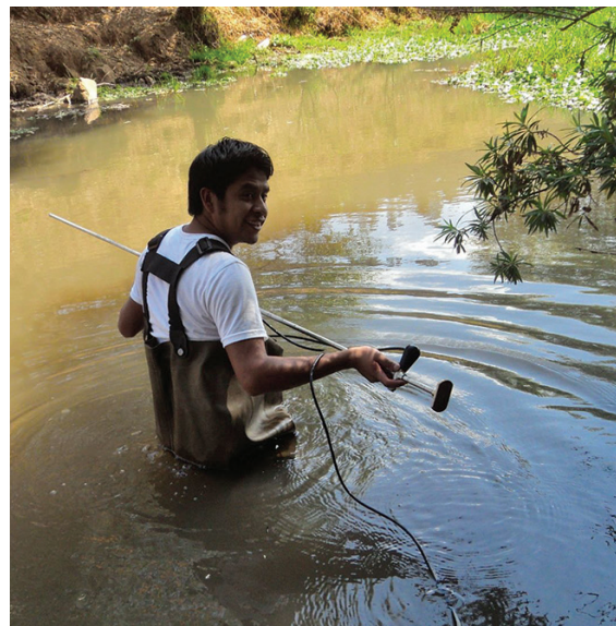
Figura 3 (a) Flujoímetro Flowmate 2000 con el cual se tomaron las velocidades del caudal, (b) toma de velocidades en el Dren Tzurumútaro.
