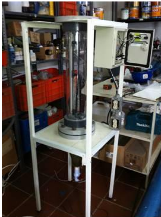
Figura 9. Presenta el sistema de biofiltro con membrana construido
