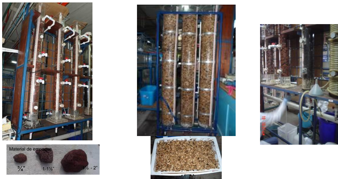
Figura 22. Presenta el montaje experimental de los trenes de tratamiento
