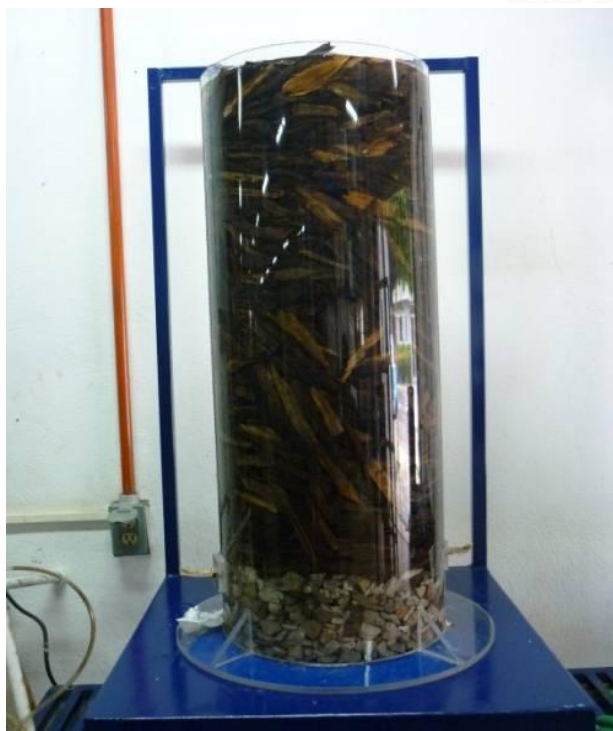
Figura 3. Ejemplo de prototipo experimental de biofiltración montado para el estudio del efecto de la granulometría en el desempeño de estos sistemas
