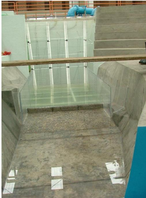
Figura 3.2 Vista del modelo físico tridimensional. Escala 1:50 (Salgado, 2011).
