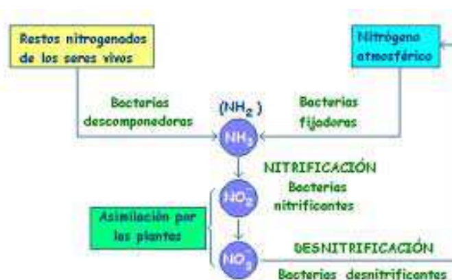
Figura 1.17 Proceso de nitrificación y denitrificación
