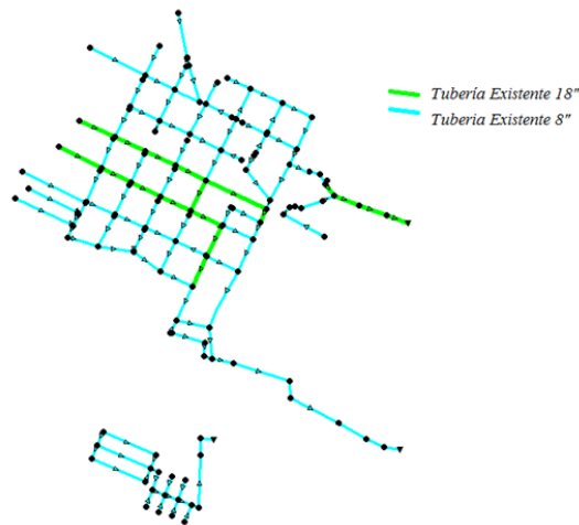
Ilustración 19. Red de alcantarillado de Erongarícuaro y sus diámetros.
