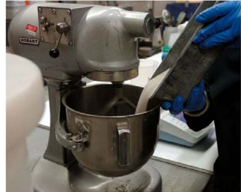
Ya mezclando se agrega la arena
