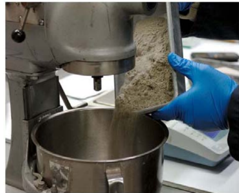
Se agrega el cemento
