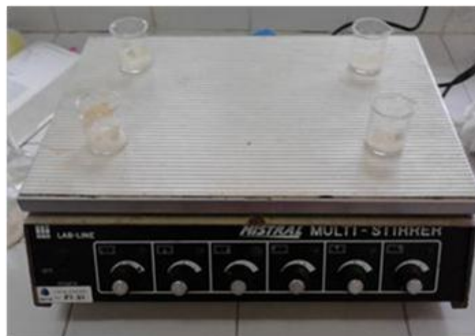
Figura 4.5. Pruebas de regeneración de alúmina activada con diferentes concentraciones de NaOH
