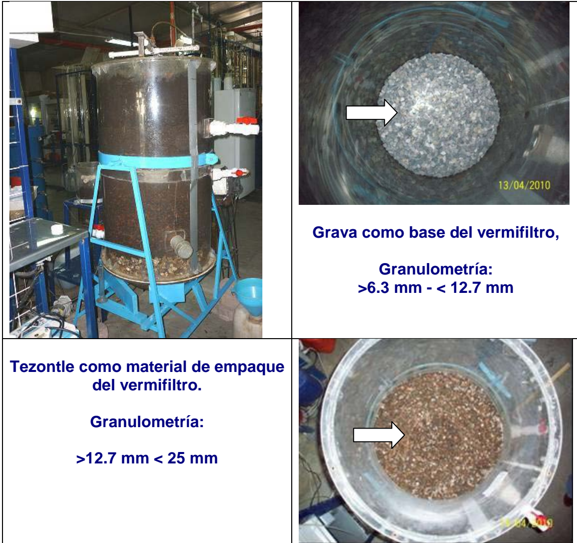
Fotos 18 a 20.-Distribución de materiales filtrantes en el vermifiltro piloto capa de grava triturada y tezontle rojo
