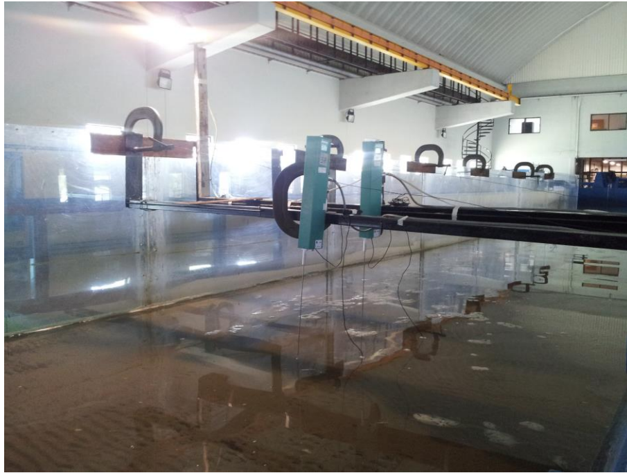
Fig. 5. Sistema de medición de oleaje del tanque del Instituto Mexicano del Transporte.
