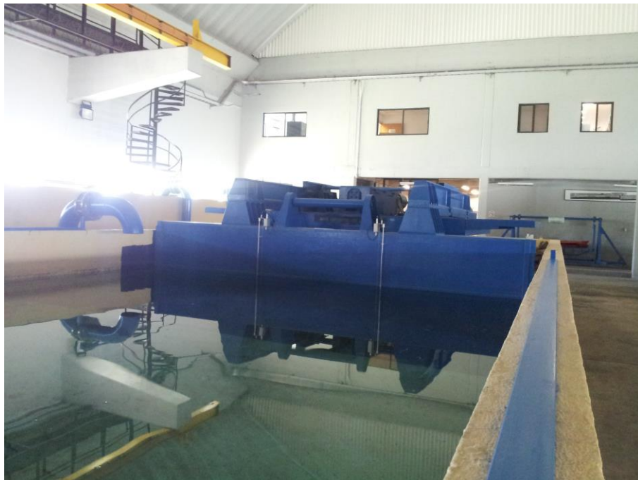
Fig. 6. Generador de oleaje del tanque del Instituto Mexicano del Transporte.
