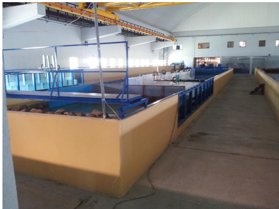
Fig. 4. Tanque de oleaje del Laboratorio de Hidráulica del Instituto Mexicano del Transporte.
