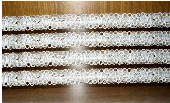
Fig. 4.7. Fotografías de los fotorreactores (izq.) y detalle del catalizador inmovilizado sobre vidrios Pyrex (der.) en un arreglo sobre una varilla de vidrio a manera de soporte
