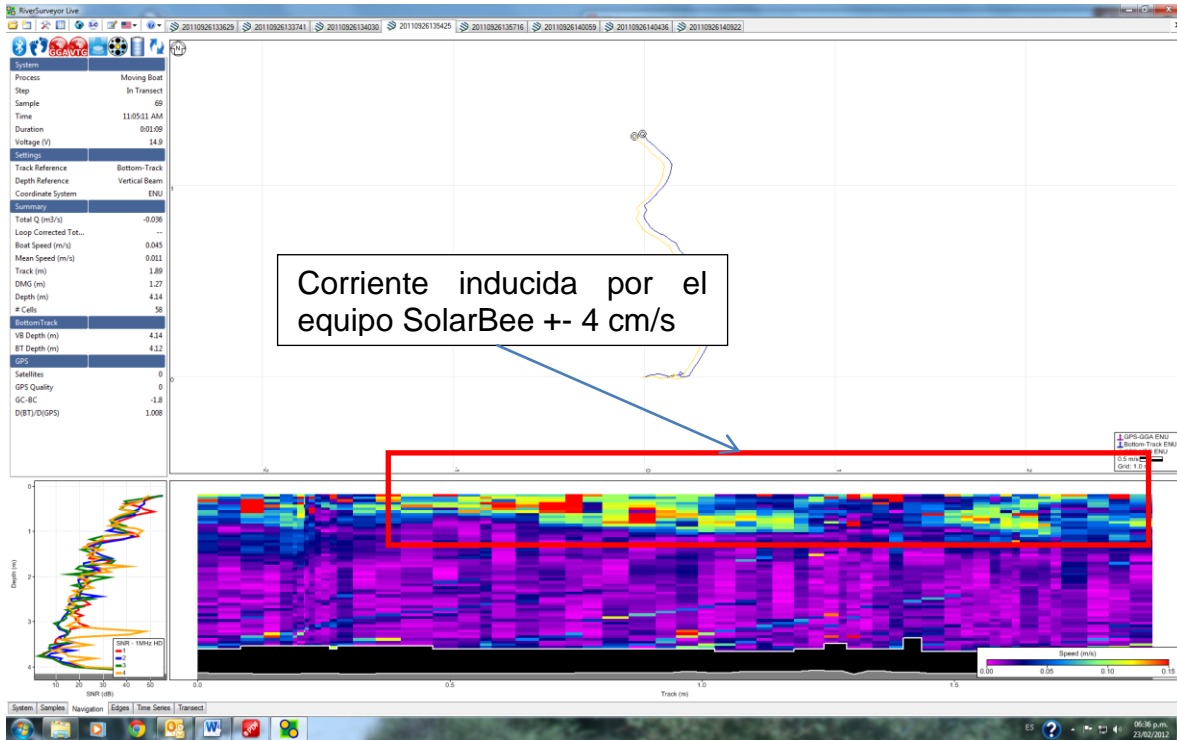
Perfiles de velocidad del agua a 1 metro de la descarga del equipo SolarBee© (se observa la descarga del flujo sobre la superficie).
