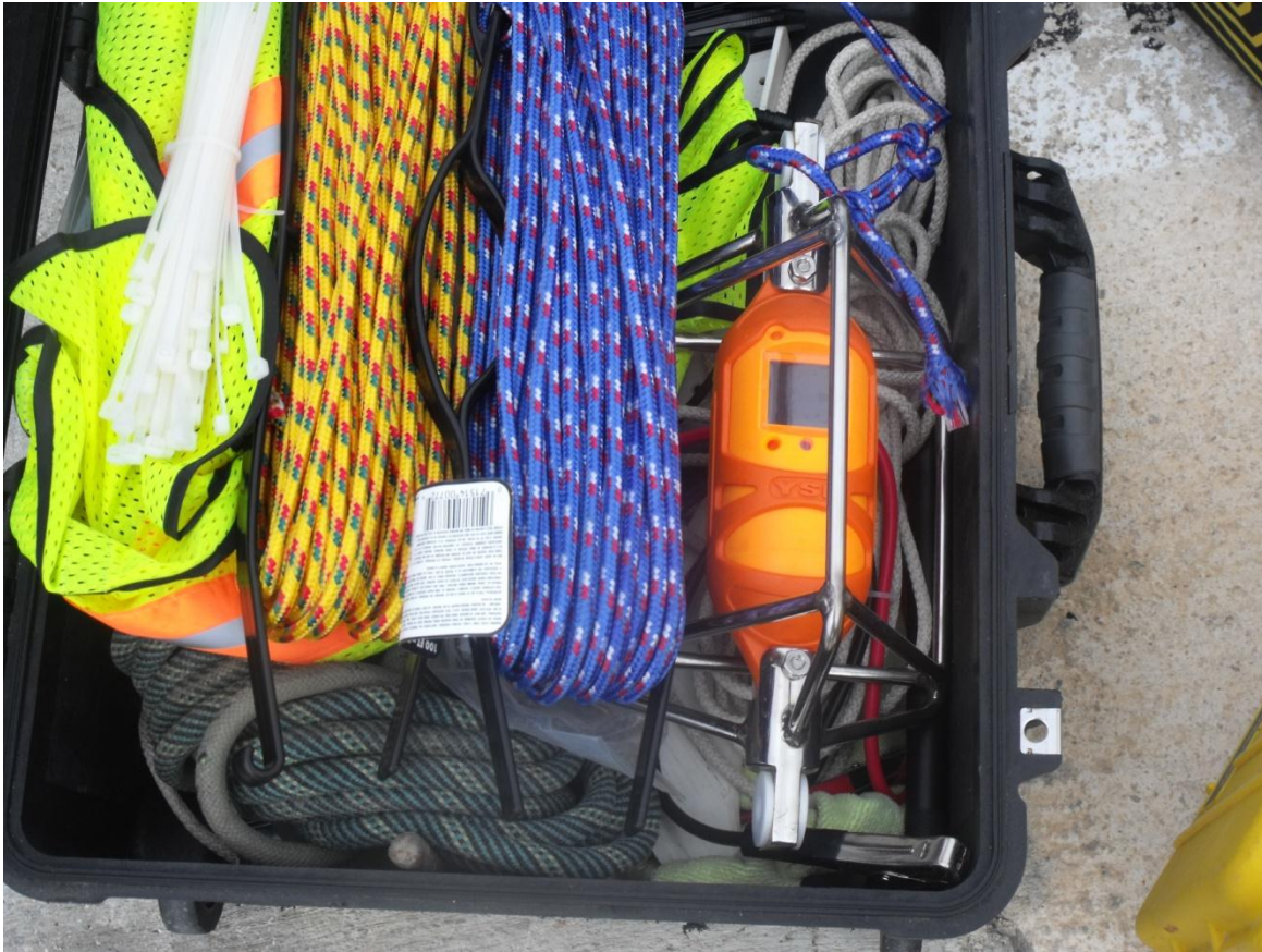
Figura 5.2.6 CTD CastAway utilizado para las mediciones en la laguna de Nichupte y Bojórquez en Cancún, Q.R
