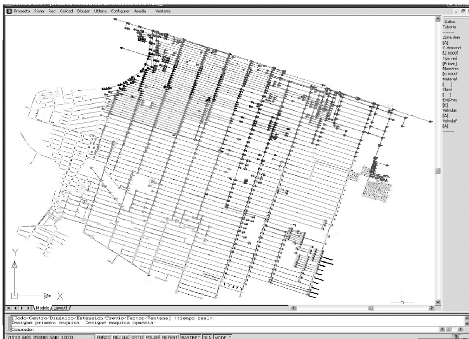
Figura 7. Resultado de la contribución de las fuentes, visualizado en el SCADRED para una red completa. Se distinguen claramente por color (tonalidades de gris) las áreas de influencia de las fuentes.
