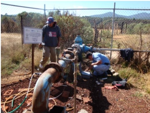
Medición con equipo ultrasónico portátil en la línea del pozo de producción.
