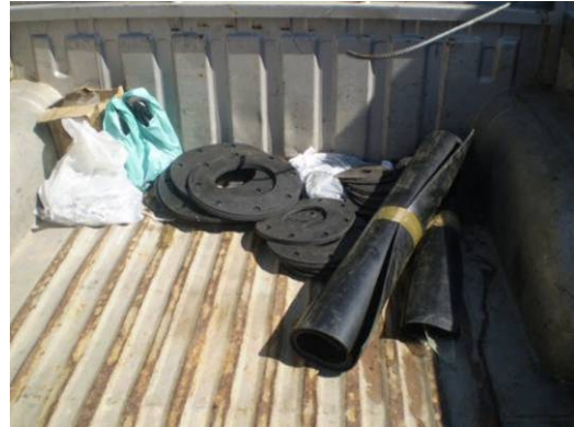
Material de reparación de fugas en válvulas
