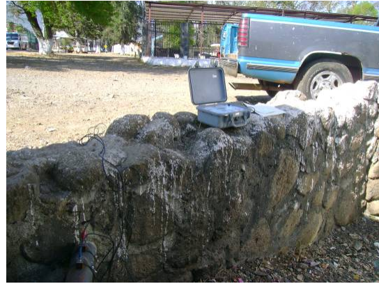
Fotografía 3.3 Medición con equipo ultrasónico portátil en manantial Ojo de Agua, Tzintzuntzan.
