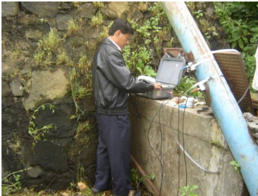
Medición con equipo ultrasónico portátil en la línea de conducción al tanque superficial
