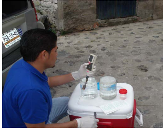
Fotografía 2-10. Obtención de los datos de campo de la muestra de agua potable en el pozo somero ubicado en la calle Adolfo Ruíz Cortinez, Ihuatzio, Tzintzuntzan, Mich.
