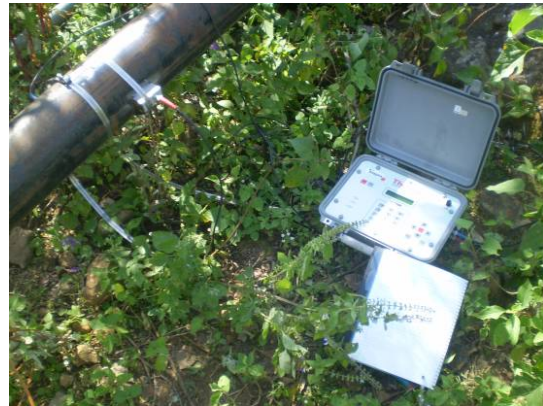
Medición con equipo ultrasónico portátil en la línea de conducción al tanque principal.
