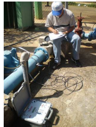
Medición con equipo ultrasónico en la línea del pozo Mezquite.
