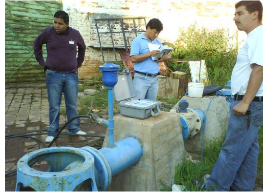
Aforo con equipo ultrasónico en la línea del pozo de producción #1.
