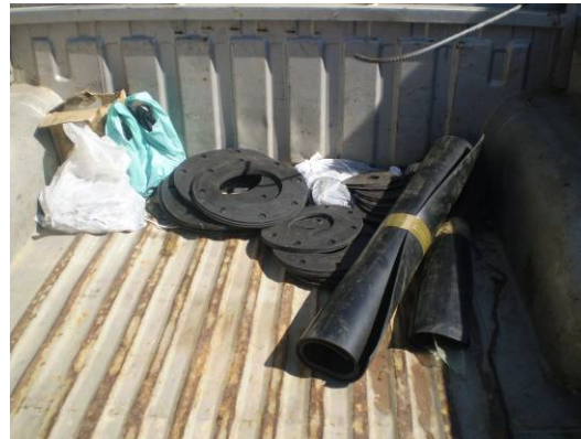
Material de neopreno para reparación de fugas
