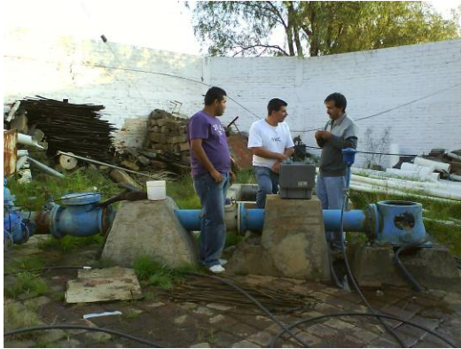
Aforo con equipo ultrasónico en la línea del pozo de producción #1.
