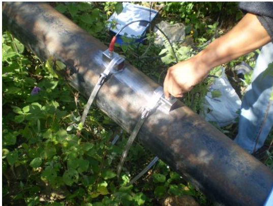
Medición con equipo ultrasónico portátil en la línea de conducción al tanque principal.
