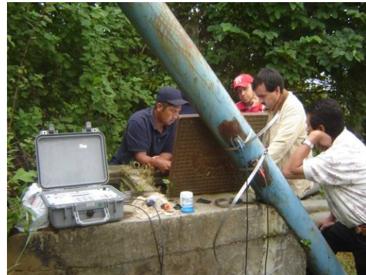
Medición con equipo ultrasónico portátil en la línea de conducción al tanque superficial
