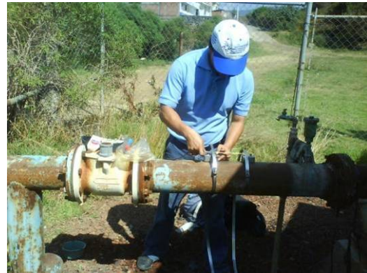
Medición con equipo ultrasónico portátil en la línea del pozo de producción.
