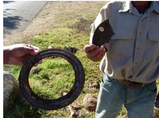
Mantenimiento a válvula de 6" que presentaba fuga a causa de los sellos deteriorados
