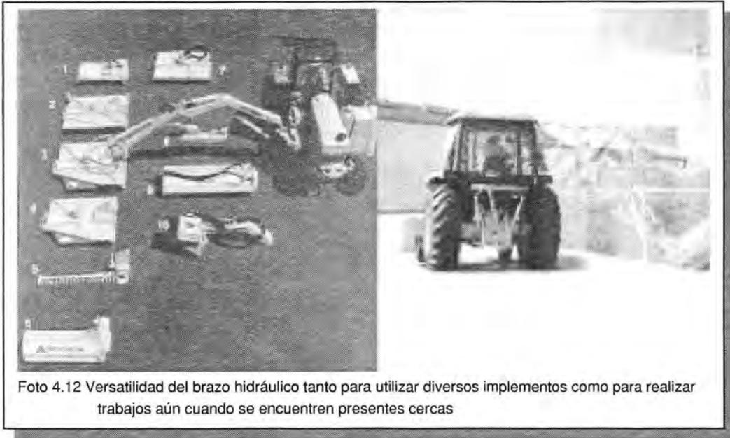
Foto 4.12 Versatilidad del brazo hidráulico tanto para utilizar diversos implementos como para realizar trabajos aún cuando se encuentren presentes cercas
