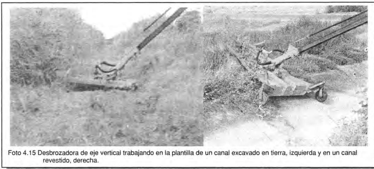
Foto 4.15 Desbrozadora de eje vertical trabajando en la plantilla de un canal excavado en tierra, izquierda y en un canal revestido, derecha.
