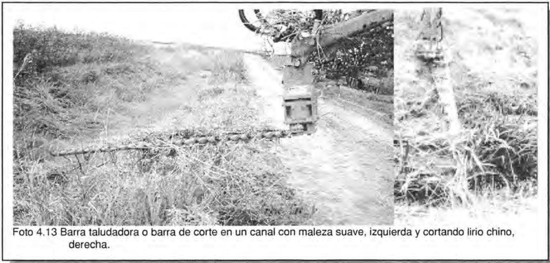
Foto 4.13 Barra taludadora o barra de corte en un canal con maleza suave, izquierda y cortando lirio chino, derecha.
