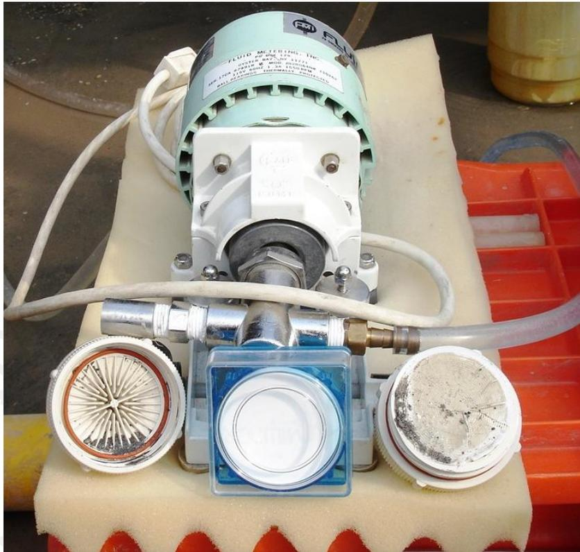
Figura 9 Equipo utilizado en el filtrado de muestras con membrana de celulosa de 0.45 micrones para eliminar las partículas de minerales que alteren la composición química de las muestras de agua.
